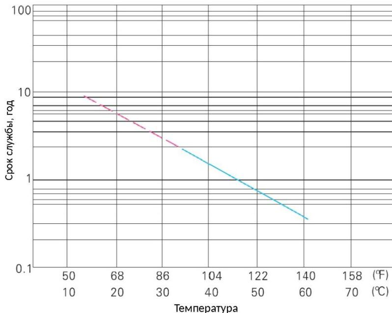
Рисунок 6 - График зависимости срока службы аккумулятора в зависимости от температуры
