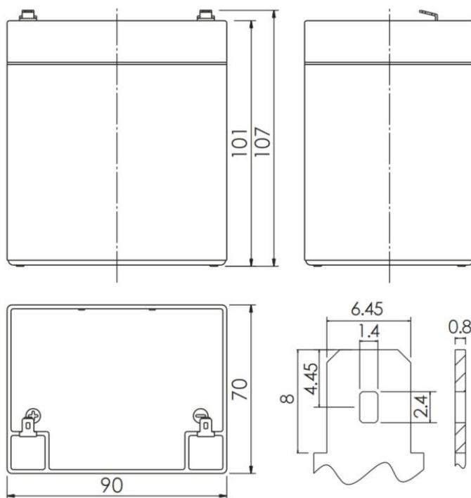
Рисунок 8 - Габаритные размеры аккумулятора
