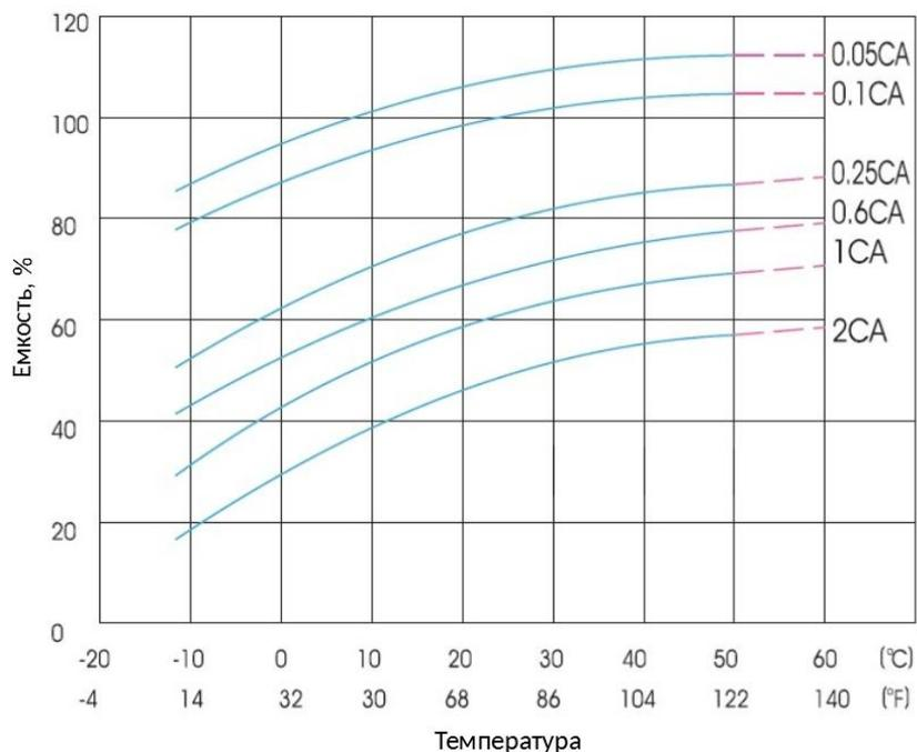
Рисунок 5 - График снижения ёмкости в зависимости от температуры
