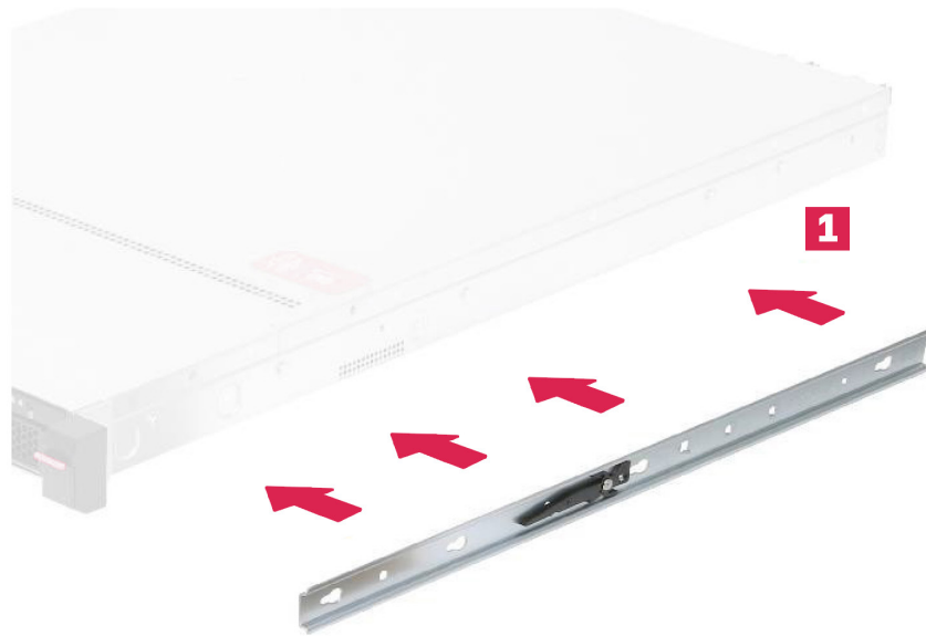
Установка направляющего рельса-1 (84N314610-003)
