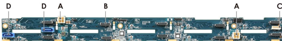
Вид бэкплейна сзади
