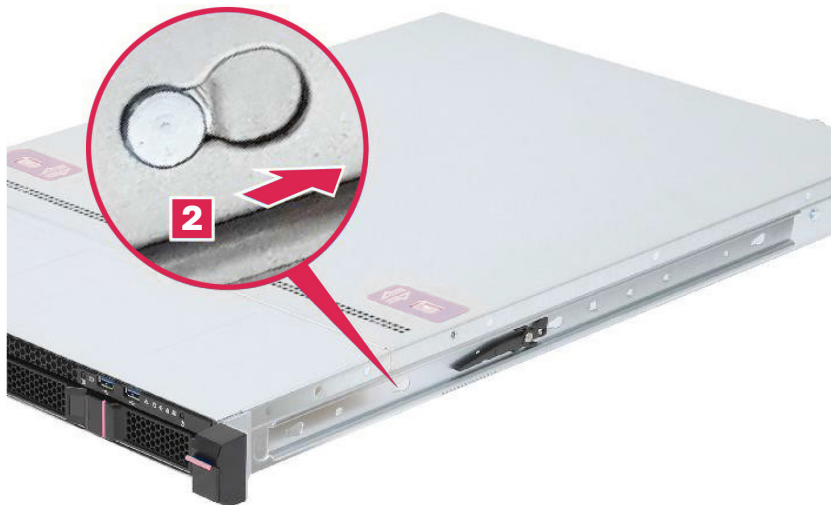
Установка направляющего рельса-2 (84N314610-003)
