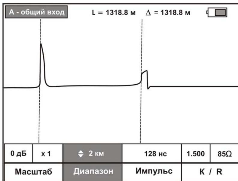
В зависимости от выбранного диапазона прибор сам устанавливает оптимальную ширину импульса. Однако измеритель может изменять этот параметр для получения более четкой картинке. Для этого нажмите кнопку «**Импульс**» (F3) и с помощью кнопок «↑», «↓» выберете наиболее информативное значение. На малых расстояниях следует пользоваться короткими импульсами, а на больших – более длинными:
