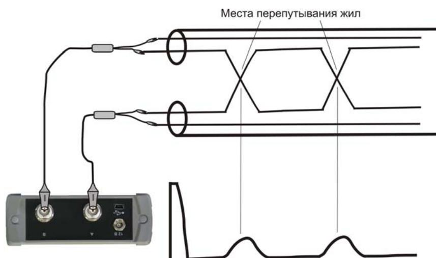
В режиме с двумя активными общими входами («А» и «В») зондирующие импульсы подаются в разные жилы, и на экране отображается одновременно оба отраженных сигнала. Такой режим позволяет визуально сравнить жилы и выбрать лучшую, с наибольшей степенью однородности.
