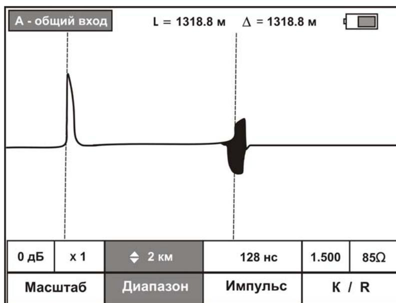
«Калибровочные метки» - данный режим предназначен для проведения поверки (калибровки) прибора.
