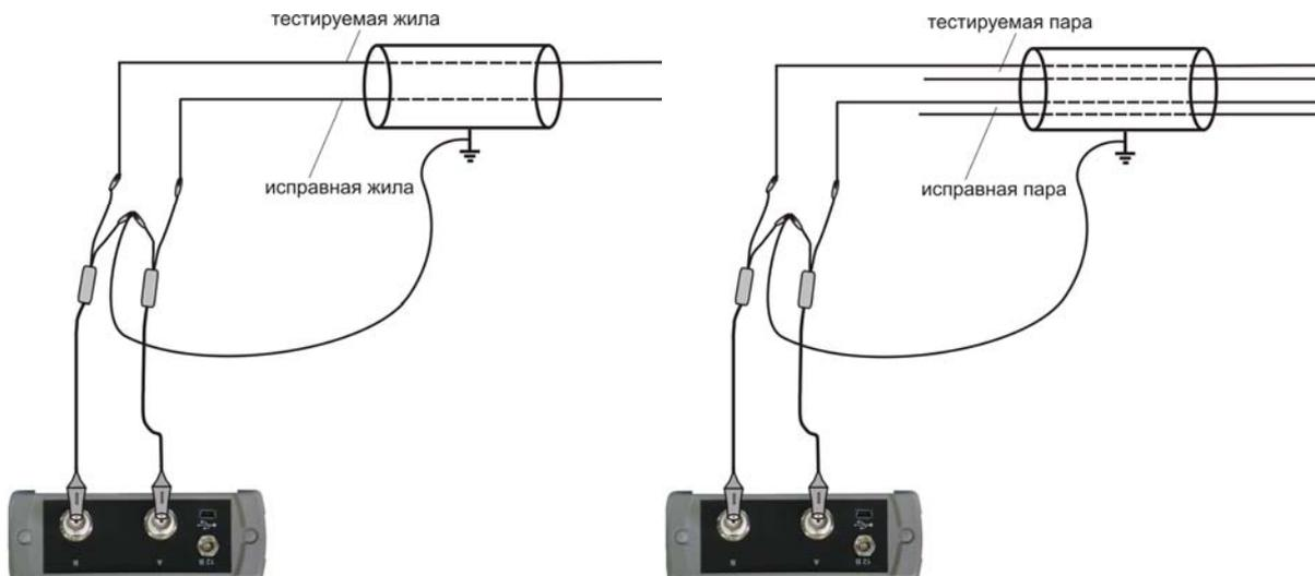
Отображаемая на экране разница отраженных сигналов позволяет точно определить расстояние до места, где жилы (пары) отличаются друг от друга. Поскольку на экране показана разность сигналов, то по виду рефлектограммы нельзя судить о характере неисправности (обрыв, короткое замыкание или низкий импеданс цепи). Для уточнения используйте режим общего входа.
