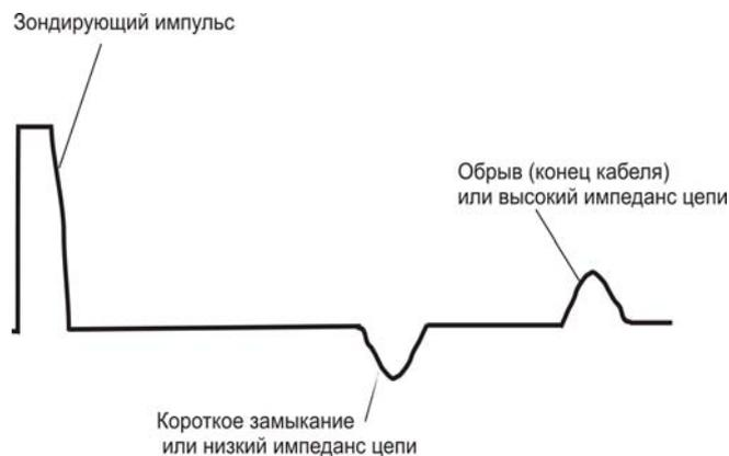
Наилучшие результаты достигаются при непосредственном подключении к паре. Линия передачи «жила-экран» обладает большим коэффициентом затухания и уровнем шумов.
