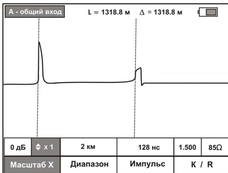
Корректное измерение расстояния проводится после установки соответствующего коэффициента укорочения для измеряемого кабеля. Нажмите кнопку «**K / R**» (F4). В активном режиме «**K укор**» с помощью кнопок «**↑**», «**↓**» установите желаемое значение коэффициента укорочения:
