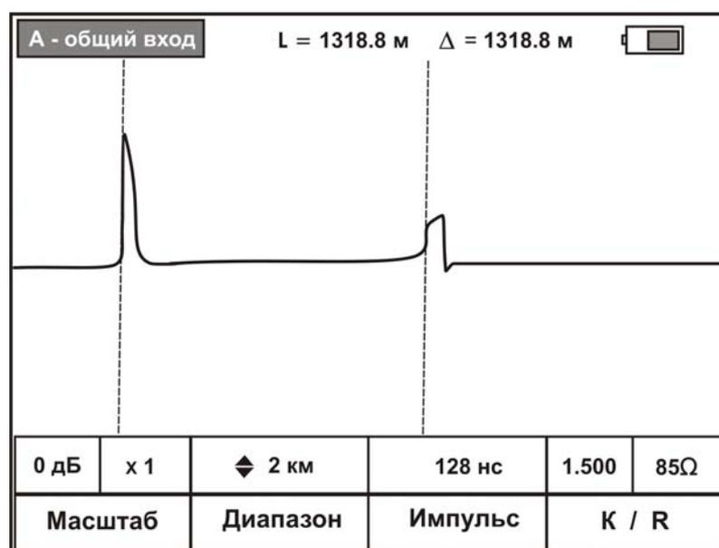
Для изменения размера по вертикальной оси нажмите кнопку «Масштаб» (F1). Затем в установившемся активном режиме «Масштаб Y» с помощью кнопок «↑», «↓» выберете наиболее информативное значение:
