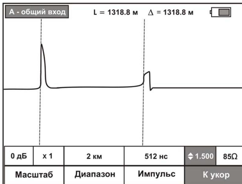
Если коэффициент укорочения неизвестен, но точно известна длина кабеля, установите измерительный курсор на конец кабеля. Затем, изменяя коэффициент укорочения выставите расстояние до измерительного курсора равное реальной длине. Полученный при этом коэффициент укорочения будет искомым. Данный метод хорошо работает для кабелей без вставок.
