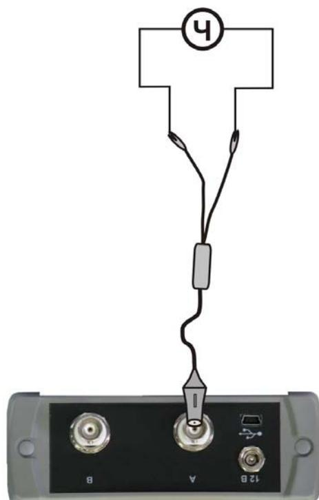
Проведите измерение частоты следования калибровочных меток с помощью частотомера. Частота следования калибровочных меток должна составлять  $1\,000 \pm 0,5$  кГц.
