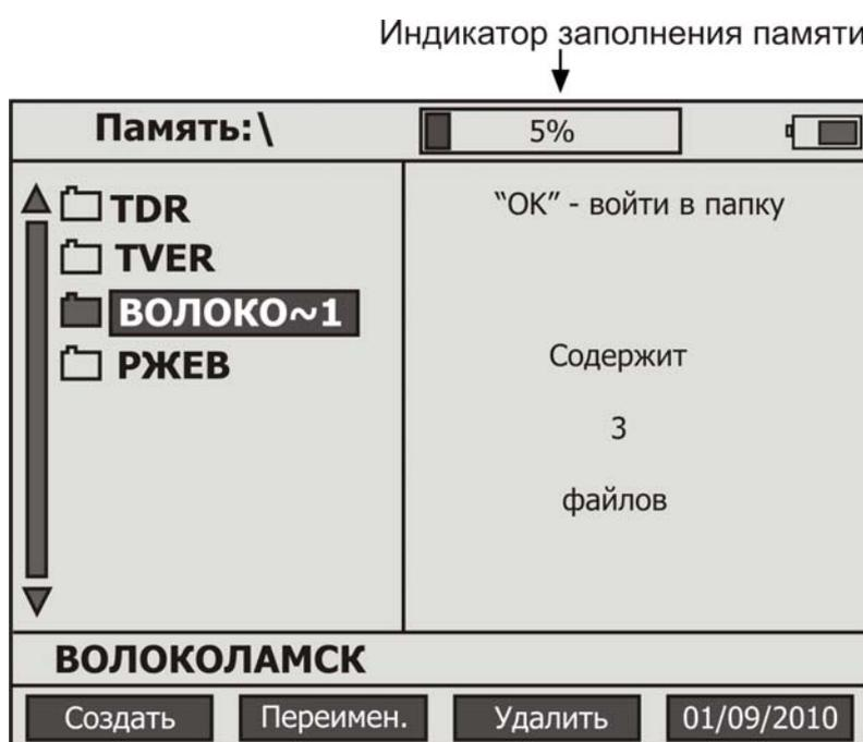
Перемещение между папками - кнопками “▲” и “▼”. Вход внутрь папки - кнопкой «Ok». Кнопка «Esc» возвращает в режим текущих измерений.
