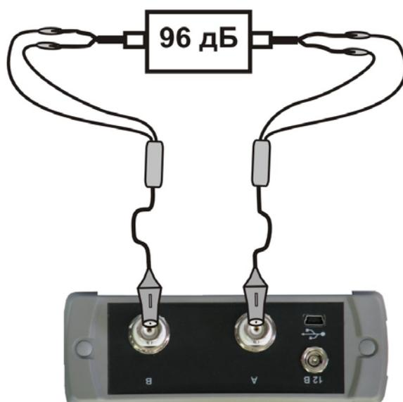
С помощью кнопок «Масштаб Y» (F1) и «↑», «↓» установите максимальное усиление сигнала.
