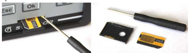
Включите генератор. Регистрация SIM карты занимает некоторое время. Этот процесс отображается на экране. После успешной регистрации в сети на экране появиться значок (GSM управление доступно), в противном случае - (GSM управление недоступно).
