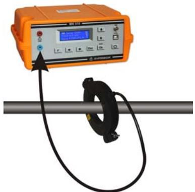
Прибор МК 510 также можно бесконтактно подключить к кабелю с помощью индукционных клещей<sup>5</sup> (КИ-90). Клещи представляют собой индукционную катушку с разъемным магнитопроводом, который замыкается вокруг тестируемого кабеля. При таком подключении достигается более высокий уровень сигнала в линии и значительно снижается влияние на соседние магистрали.
