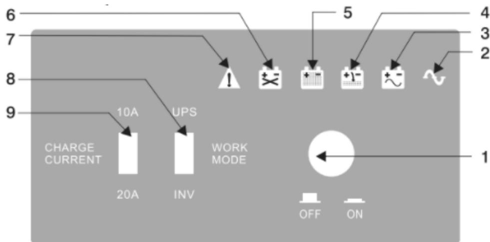
Рисунок 1 – Общий вид лицевой панели инвертора
