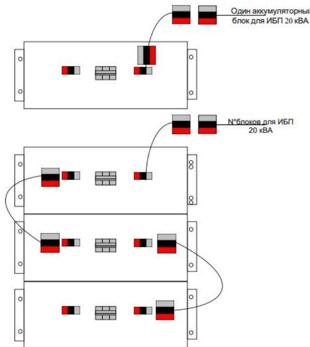
РИСУНОК 9 - ПОДКЛЮЧЕНИЕ К ИБП 10-20 кВА
