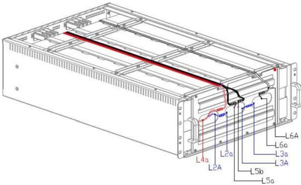
РИСУНОК 13 - ПОДКЛЮЧЕНИЕ КАБЕЛЕЙ
