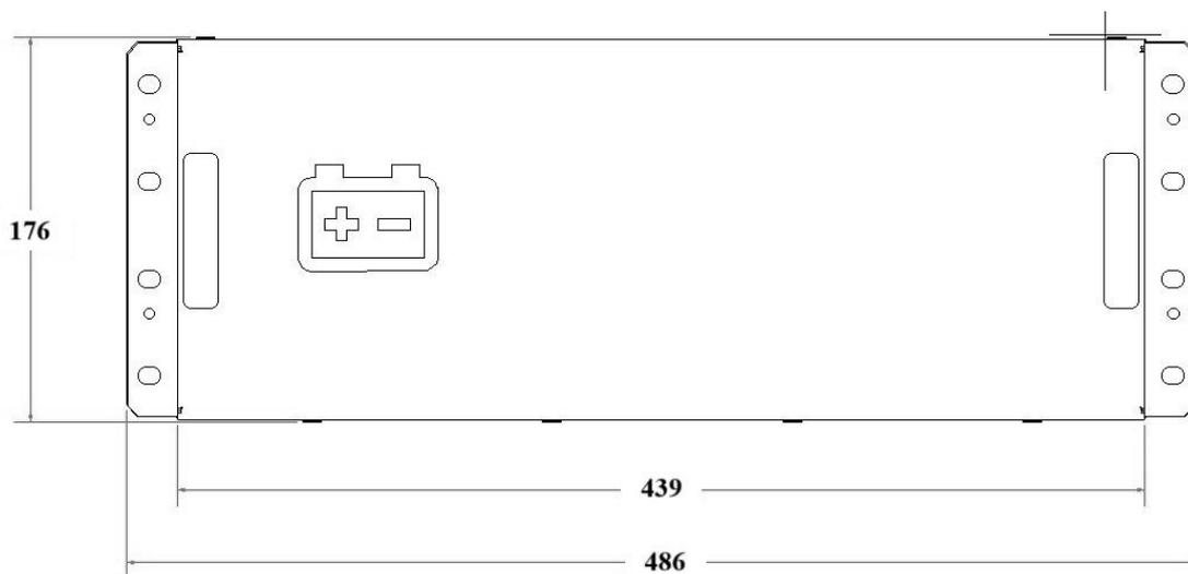
РИСУНОК 5 – ГАБАРИТНЫЕ РАЗМЕРЫ. ВИД СПЕРЕДИ
