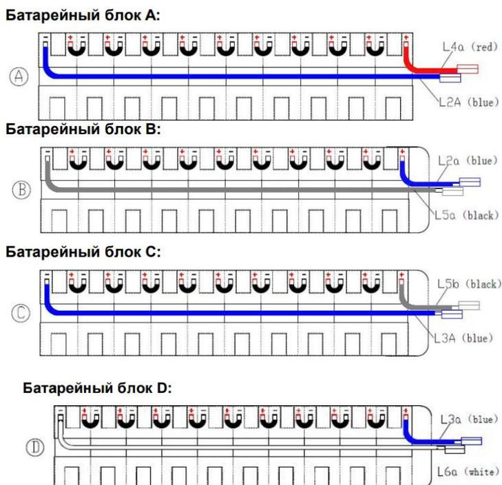
РИСУНОК 10 - ПОДКЛЮЧЕНИЕ АККУМУЛЯТОРОВ В БАТАРЕЙНЫХ БЛОКАХ
