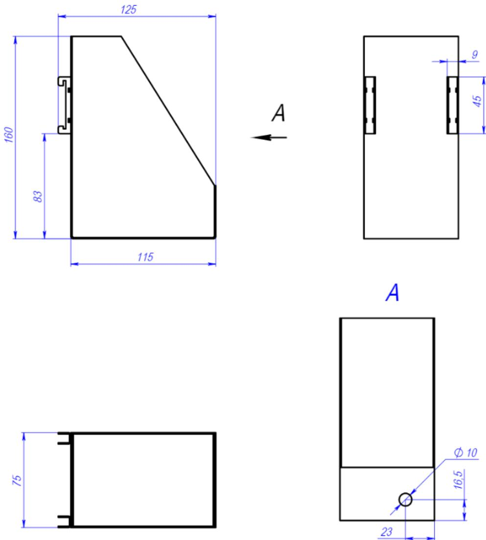
РИСУНОК 1 – Габаритные размеры кейса
