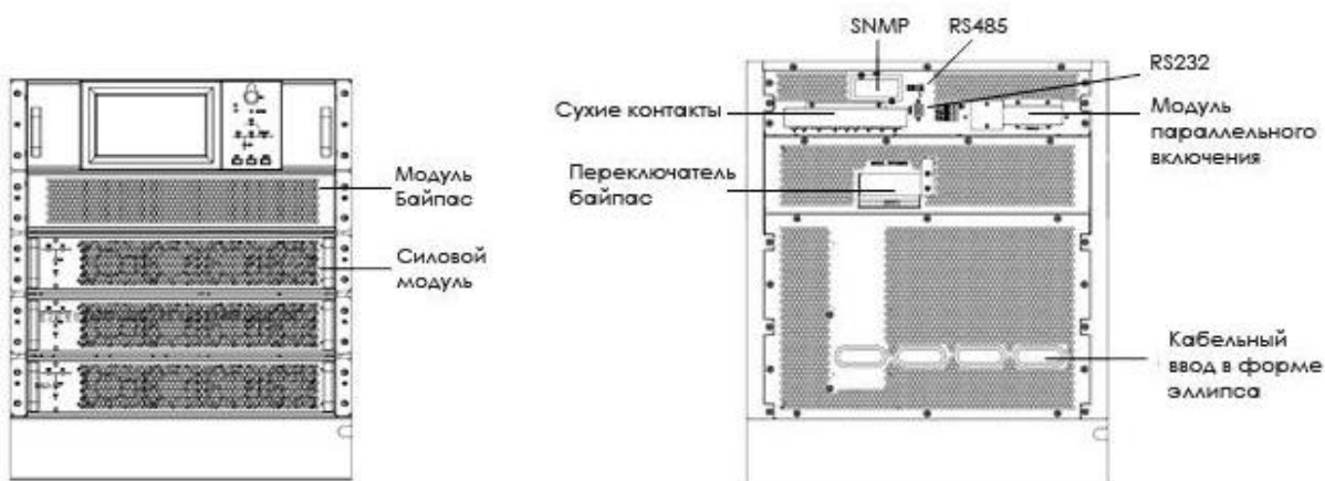
Рисунок 3 – Шасси ИБП с 3 силовыми модулями
