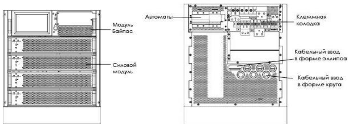
Рисунок 2 – Шасси ИБП с 4 силовыми модулями
