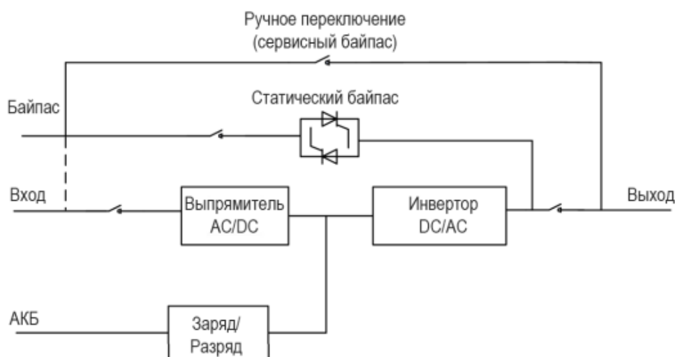
Рисунок 1-1 Структурная схема ИБП
