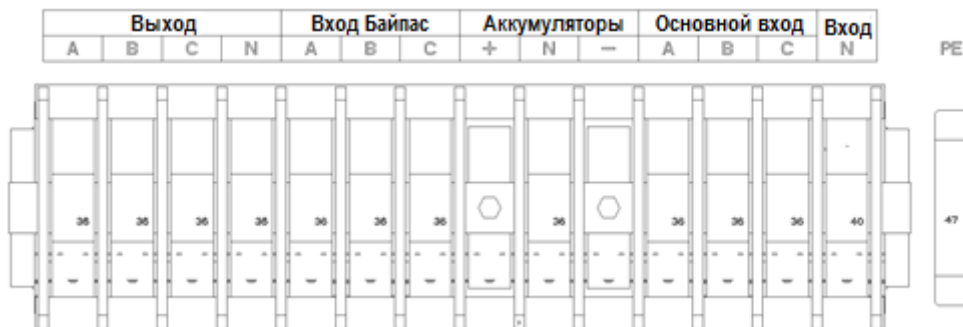
(г) Соединения терминалов 10-слотового шкафа
