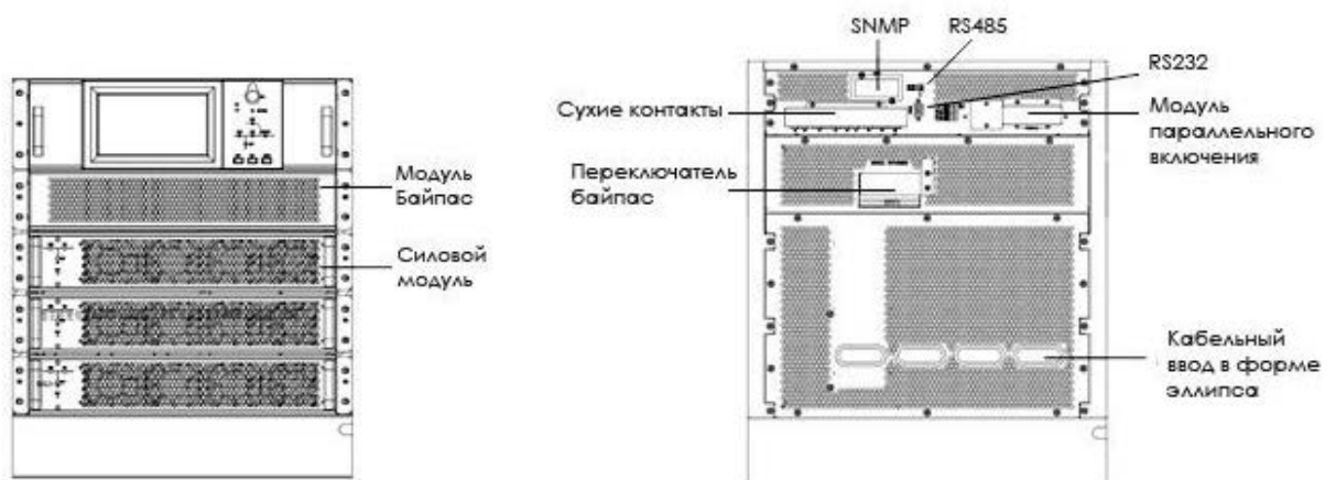
Рисунок 3 – Шасси ИБП с 3 силовыми модулями
