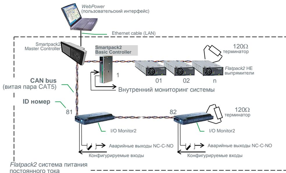
Рис 3 Пример расположения шины CAN bus и ее ограничения в системе электропитания *Flatpack2* с контроллером *Smartpack2* и двумя мониторами "I/O Monitor2 nodes" для ввода/вывода подсоединенными к шине CAN bus
