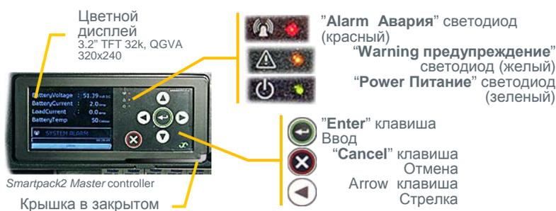
Рис 4 *Smartpack2 Master* -клавиши и индикаторы передней панели
