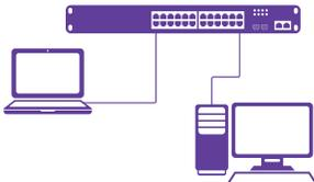
Соедините порт коммутатора с сетевой картой ПК, подключите питание к коммутатору. Настройте на сетевой карте ПК IP-адрес из диапазона 192.168.1.2-254, например 192.168.1.100 и подключитесь по протоколу Telnet к IP-адресу 192.168.1.1.
