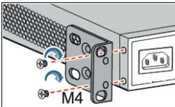
Прикрутите винты и установите устройство в стойку. Внимание: оставляйте промежуток между оборудованием не менее 1U для теплоотвода.
