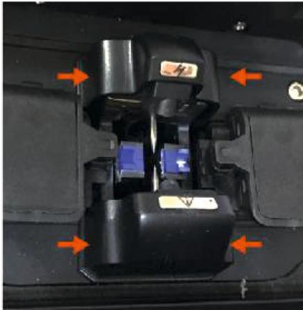
2. Крышки отличаются размерами. Правая крышка (см.изображение) устанавливается ближе к экрану сварочного аппарата.
