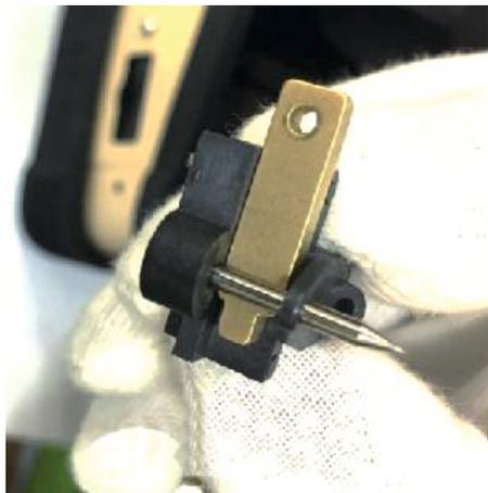
10. Используя отвертку, вставьте защелку и затяните винт.
