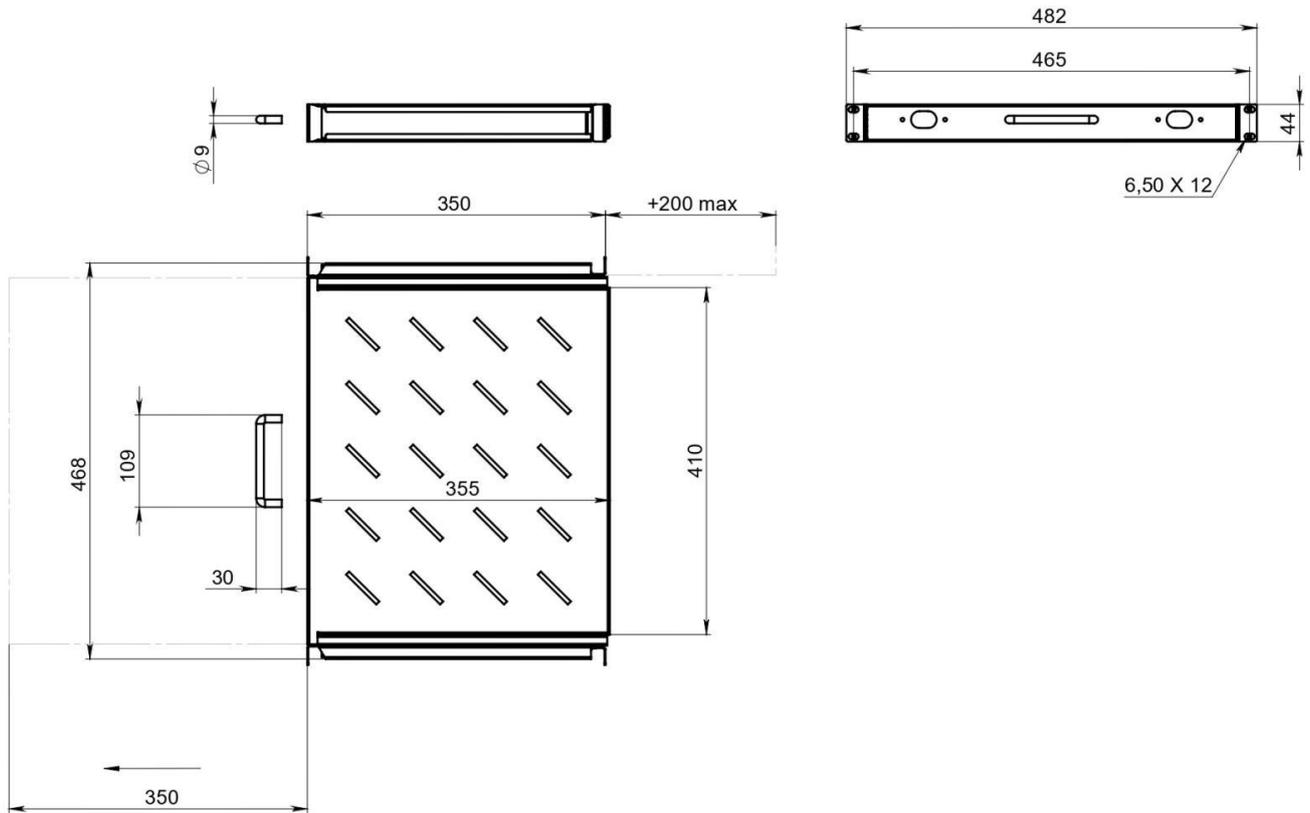
РИСУНОК 3 – ГАБАРИТНЫЕ РАЗМЕРЫ МОДЕЛЕЙ SNR-SHELF-06035-20GS И SNR-SHELF-06035-20BS
