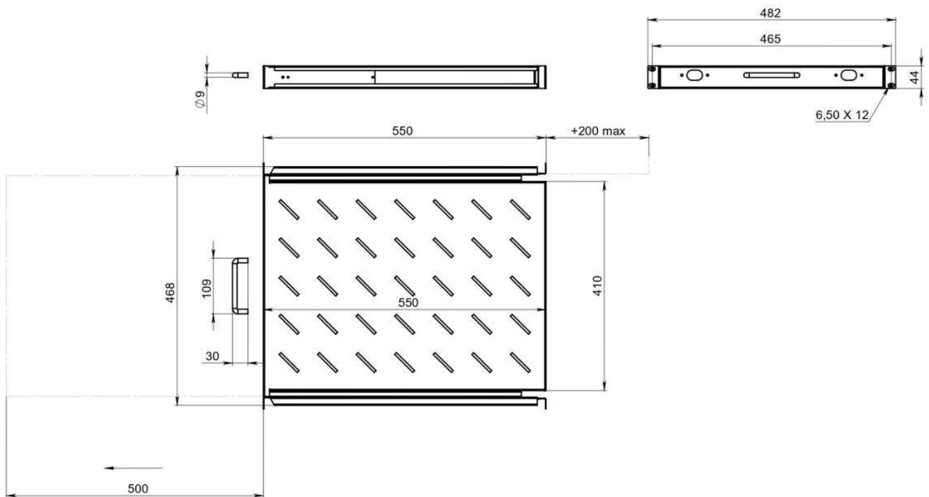
РИСУНОК 5 – ГАБАРИТНЫЕ РАЗМЕРЫ МОДЕЛИ SNR-SHELF-10055-20BS И SNR-SHELF-10055-20GS
