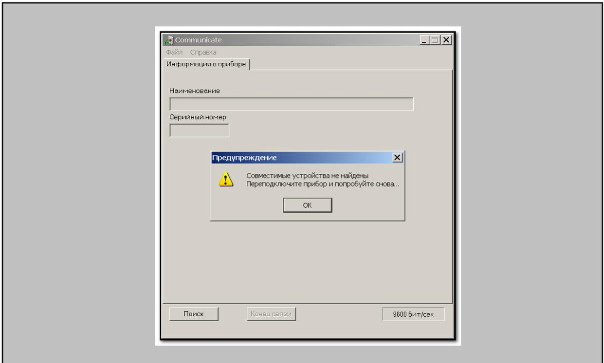
*Ответ:* нарушено соответствие типа подключения и используемого программного обеспечения. Программа **Communicate** используется только для **IrDA** и **USB-последовательного** соединений
