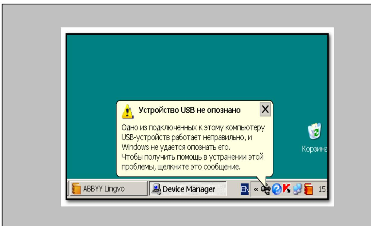
**Ответ:** порядок подключения прибора к компьютеру нарушен, возможно, прибор был включен с подключенным USB-кабелем. Отсоедините USB-кабель и вновь подсоедините его к прибору. Случается, что помогает. Если не получилось, то отсоедините USB-кабель, выключите и вновь включите прибор. Подсоедините USB-кабель в момент, определяемый выбранным Вами видом USB-соединения.
