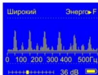
Режим позволяет проводить трассировку скрытой проводки, находящейся под напряжением. Максимум спектра приходится на 50 Гц. В спектре также присутствуют гармоники, которые зависят от
