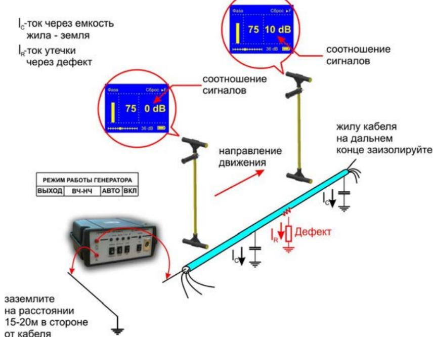
Режим «НЧ-ВЧ» использует двухчастотный метод, в котором генератор в режиме «НЧ-ВЧ» посылает в линию сигналы сразу на двух частотах. Поскольку глубина залегания и условия прохождения трассы влияет на сигналы одинаково, их соотношение остается
