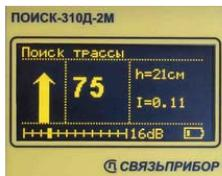
Подключите индуктивный определитель к приемнику. Расположите определитель над искомым кабелем для поиска «по максимуму», как показано выше. Выберете режим «Поиск трассы». Дождитесь окончания автонастройки прибора. Нажав кнопку **F**, зафиксируйте направление.
