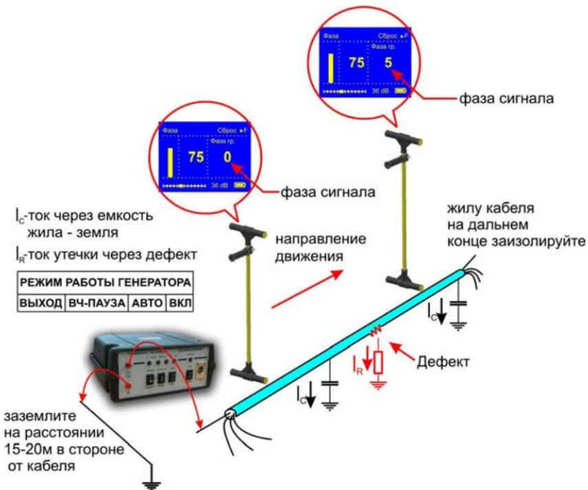
Режим «ФАЗА» использует двухчастотный фазовый метод. Генератор в режиме «ВЧ» посылает в линию сигнал сразу на двух частотах. После прохождения повреждения фаза сигнала изменяется.
