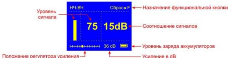
Обнулите показания кнопкой **F**. При движении вдоль трассы могут «набегать» отрицательные показания. Их следует обнулять.
