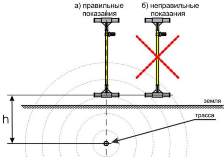
Не проводите измерение глубины залегания коммуникации вблизи поворотов, отводов или тройников. Отступите, по крайней
