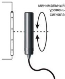
**Определение направления прокладки кабеля:** при вращении определителя вокруг своей оси над кабелем, положение с минимальным уровнем сигнала покажет направление прокладки кабеля.
