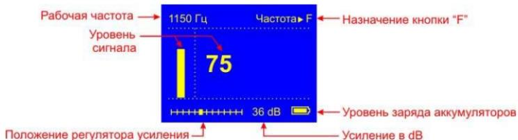
Для изменения частоты работы приемника, нажмите **F**. Выберете изменяемую цифру, нажав **F**, измените значение, нажав **▲** или **▼**. Для возврата нажмите **OK**. Установленная частота сохраняется в энергонезависимой памяти.
