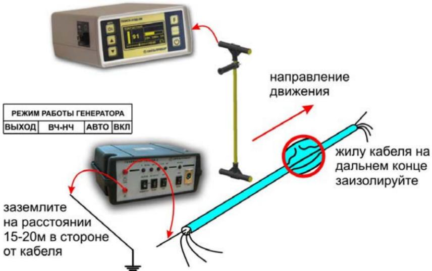
Подключите генератор к поврежденной паре. При этом рекомендуется работать на максимально коротком участке кабеля, чтобы уменьшить паразитный сигнал через емкость кабеля. Желательно, чтобы дефект был ближе к дальнему от генератора концу кабеля.
