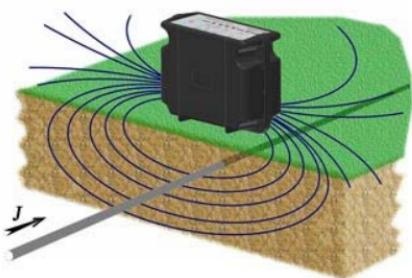
Установите генератор на земле перпендикулярно кабелю или трубе. Включите режим «**ИНДУКТОР**» и «**ВЧ-ПАУЗА**», при этом встроенный индуктор излучает переменное магнитное поле, которое порождает ток в коммуникации (показано на рисунке). Поле, возбуждаемое током контролируется трассоискателем.
