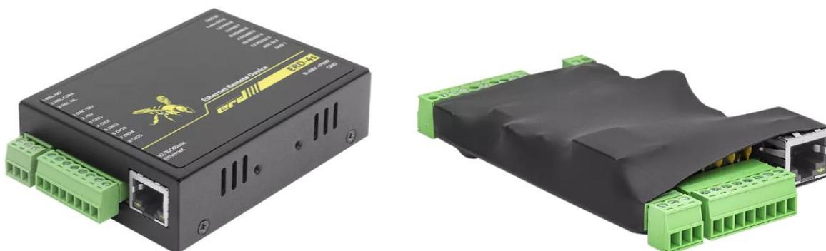
Устройство SNR-ERD-4 имеет 5 универсальных DIO контактов, способных работать как в режиме входа или в режиме выхода, в зависимости от типа настройки. Помимо DIO, устройство оснащено Реле для подключения активной нагрузки с максимальным коммутируемым напряжением - 250В, ток - 10А. Используя шину RS-485, к устройству SNR-ERD-4 могут быть подключены платы расширения DI: [RSCcounter-8i](#) и [RSCounter-16i](#) на 8 и 16 дополнительных контактов типа «вход».
