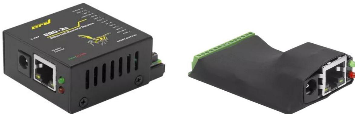
Устройство SNR-ERD-2 имеет 4 контакта для передачи логического состояния: ALARM, DI1, DI2, DI3, а так же детектор фазы для подключения блока DC-5V. Состояние «Детектора Фазы» в систему не передаётся, так как имеет другой вид OID.
