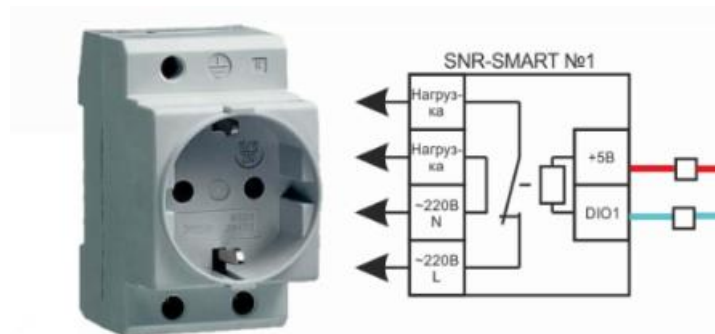
Рисунок 1 - Принцип работы розетки SNR-SMART-DIN
