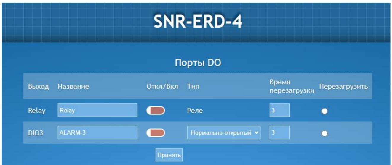
Рисунок 22 - Вкладка управления нагрузкой на ERD-4
