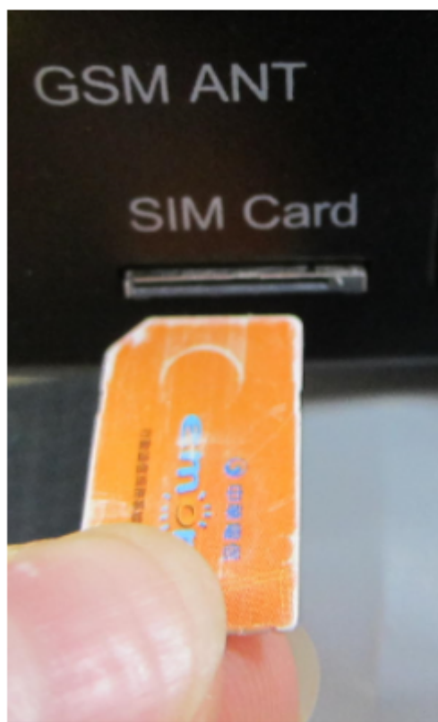
Рисунок 17 - Порядок установки SIM карты
