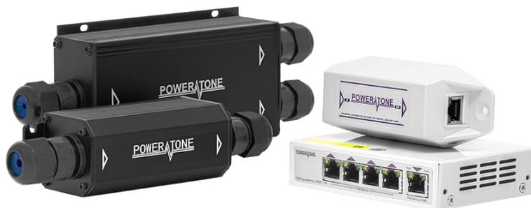
РЕХТ не требуют внешнего питания, работают от передаваемого РoE, потребляя не более 3 Вт, что является наименьшим потреблением мощности среди всех устройств данного класса. Начиная со второй серии, удлинители от POWER TONE оснащены промышленными компонентами для обеспечения непрерывной работы при -40°C.
