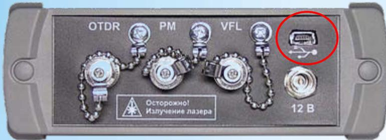
Обмен информацией между прибором и компьютером осуществляется стандартными программными средствами. После подключения к ПК прибор будет отображаться в системе как съемный диск **VISA**, доступный только для чтения.
