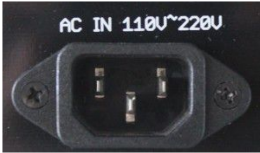
Рисунок 19 – Ввод 220В AC (устройство UniPing server solution v3)
