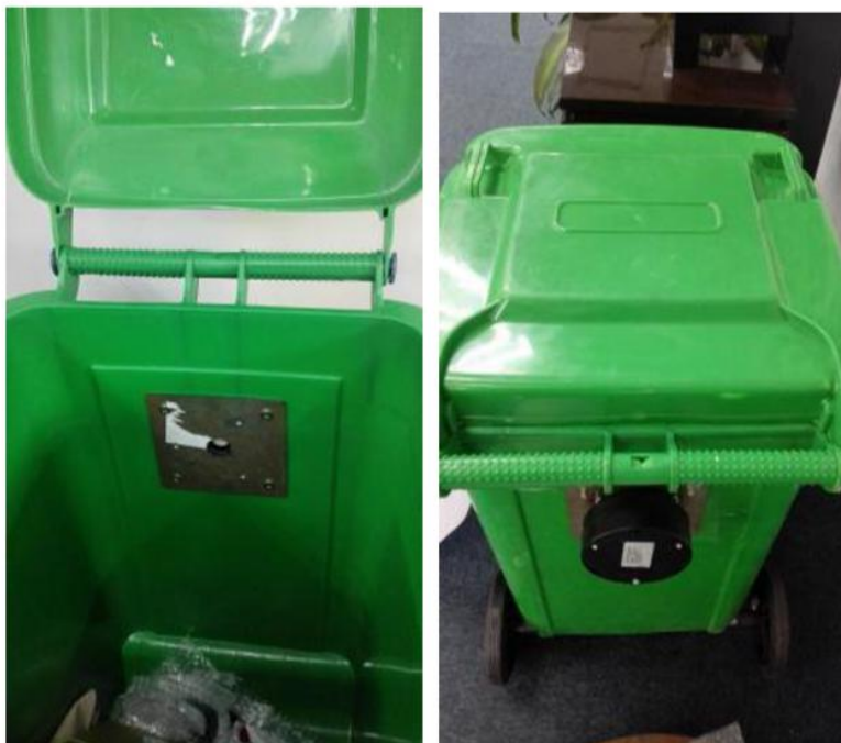
Рисунок 4: Размещение датчика на стенке бака
