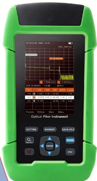
**KIWI-7300** – компактный бюджетный оптический рефлектометр, работающий на двух длинах волн с динамическим диапазоном 22дБ.
