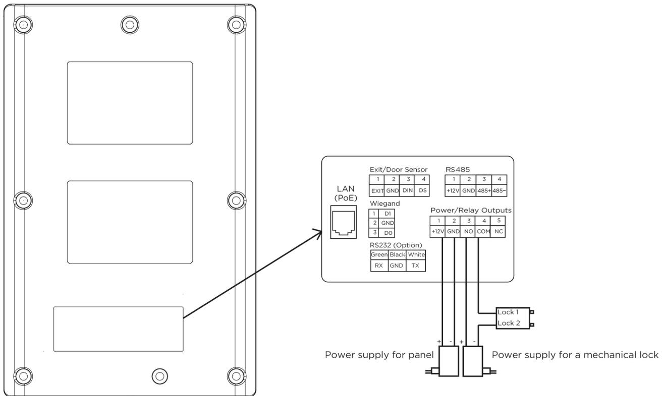
Схема подключения электромагнитного замка с использованием внешнего блока питания для замка.
