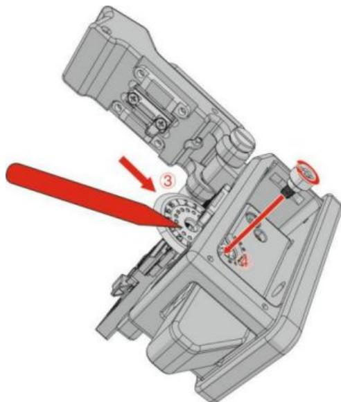
3. Установите новое лезвие, вставьте болт (1) в центральное отверстие лезвия, затяните болт при помощи восьмигранного ключа.
