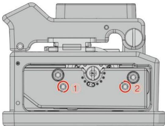
1. Для регулировки высоты лезвия отвинтите болты (1), (2) с помощью восьмигранного ключа (входит в комплект поставки).
