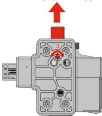
2. Поверните болт (3) с помощью восьмигранного ключа и отрегулируйте высоту лезвия: движение по часовой стрелке - перемещение лезвия вниз, движение против часовой стрелки - перемещение лезвия вверх. После регулировки высоты затяните болты (1) и (2).
