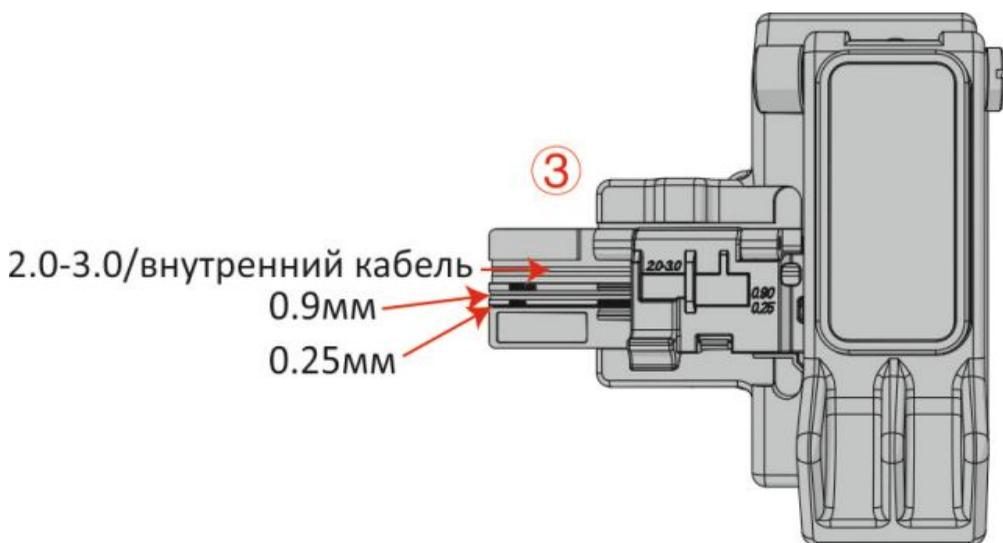
3. Для того чтобы произвести скол волокна закройте крышку прижима волокна, крышку основного блока и сдвиньте вперед подвижный блок скальвателя.
