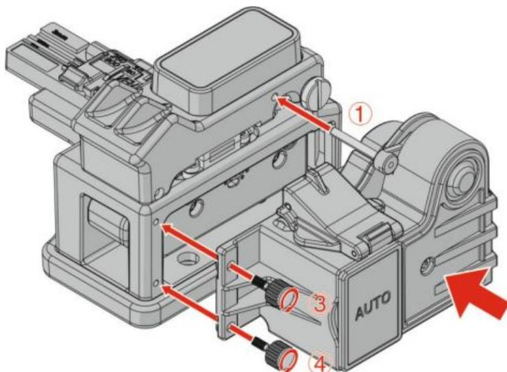
Чтобы прикрепить контейнер к основному корпусу скальвателя, установите его на места 1-4. После этого для фиксации контейнера затяните винты (3) и (4).
