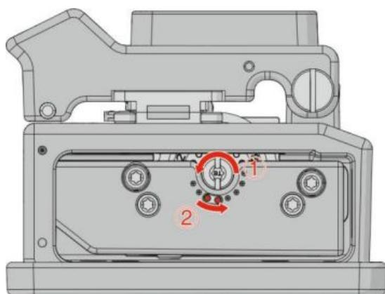
Ослабьте болт (1) с помощью восьмигранного ключа, поверните его против часовой стрелки (2) на 1-2 деления. Закрепите болт (1), когда позиция лезвия будет изменена.
