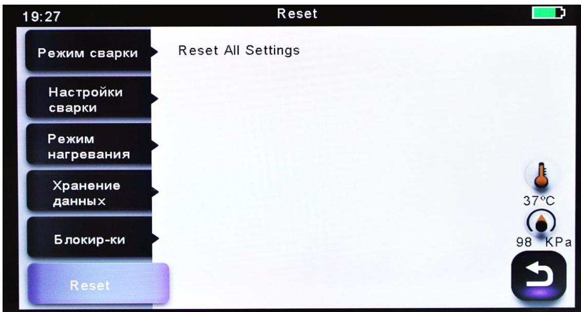
Если в работе сварочного аппарата возникла неисправность, то необходимо сбросить все параметры на заводские установки. Данная функция предназначена для специалистов сервисного центра.
