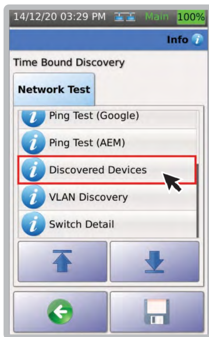
2. Для просмотра результатов измерения выберите нужный параметр, например Обнаруженные устройства [Discovered Devices].
