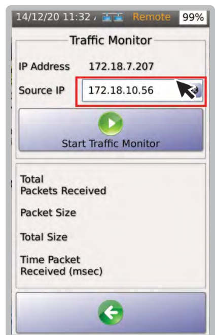
8. В поле [Source IP] введите IP-адрес основного блока TestPro, который будет генерировать трафик.
