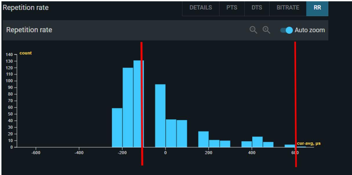
Рисунок 21 - Пример смещения PCR (среднее отклонение – слева, максимальное – справа)
