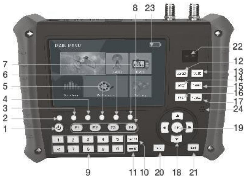
1. Выключатель питания: нажмите его на 3 ~4 секунды, чтобы включить/выключить устройство
