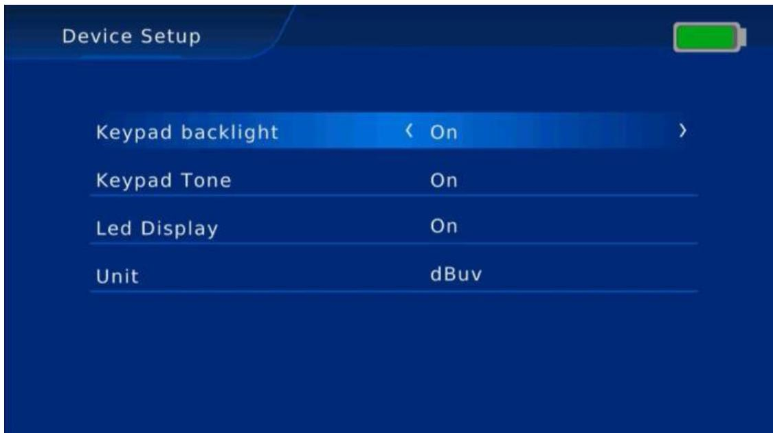
Нажмите [▲/▼], чтобы выйти на опции Подсветка клавиатуры, Звук клавиатуры, или Светодиодный дисплей, после этого нажмите press [◀ / ▶ ], чтобы выбрать режимы «Вкл» или «Выкл».
