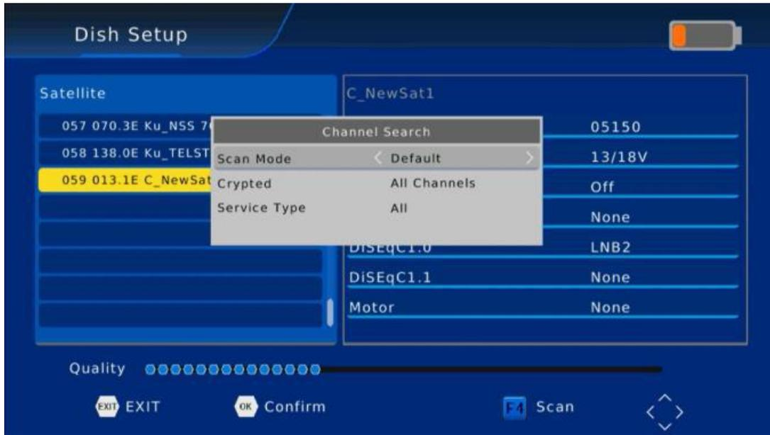
Нажмите [GOTO], чтобы попасть в список TP, Вы также можете использовать [F1] [F2] [F3] [F4], чтобы добавить, редактировать, удалить или начать сканирование выбранных TP, и нажать [GOTO], чтобы вернуться к списку спутников.
