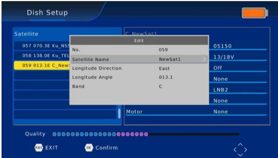
Нажмите [F3], чтобы удалить существующий спутник. Если нажмете «OK», то спутник будет удален или Вы можете нажать «EXIT», чтобы выйти.
