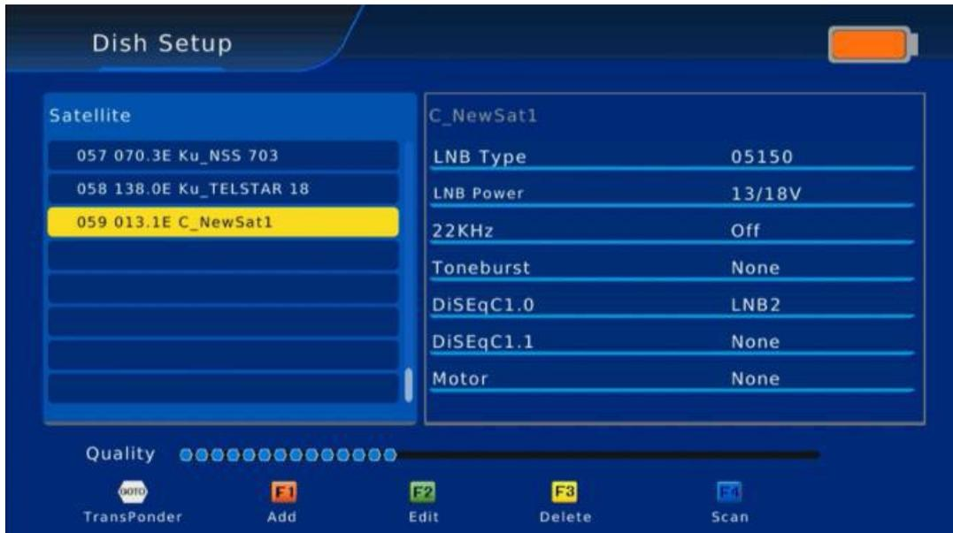
На странице списка «Спутник», Вы можете нажать [▲/▼], чтобы выбрать спутник. Нажмите [F1] чтобы добавить новый спутник с помощью настройки Спутник Номер, Название, Узел или Диапазон.
