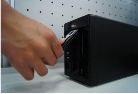
③ Потяните ручку жесткого диска вверх при установке жесткого диска
