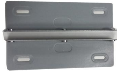
② Отделите нижнюю часть кронштейна жесткого диска и кронштейн дисководов для чтения компакт-дисков.
