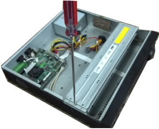
① Откройте верхнюю крышку и извлеките кронштейн жесткого диска.
