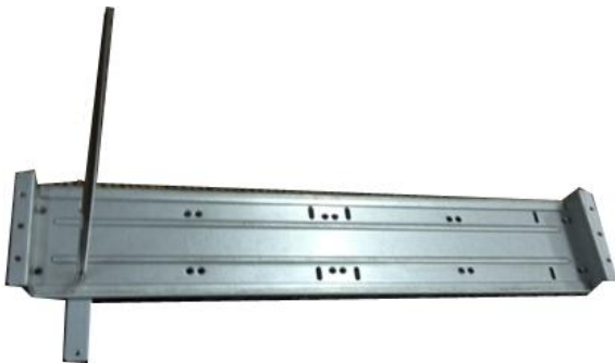
③ Прикрепите кронштейн дисководов для чтения компакт-дисков к кронштейну жесткого диска.
