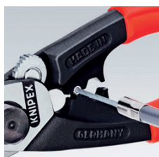
Напрессовка концевой гильзы на тяговый трос
