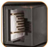
Контакты с золотым покрытием 50 мкд: не менее 750 циклов подключения
