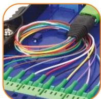
Предустановленная сборка Hydra fan-out внутри кассеты, собирающая 12 портов SC или LC в один высокоплотный MTP
