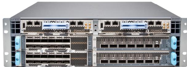
Маршрутизатор MX10003 от компании Juniper Networks с оптимизированным энергопотреблением, в первую очередь был создан для облачных провайдеров и хостинг операторов. Он имеет большую плотность портов и высочайшую пропускную способность и при этом размеры его 3 U. При 4,8 Тбит/с пропускной способности, в MX10003 поддерживается до 72 портов 10gbe интерфейсов, 18 портов 40gbe или 12 портов 100gbe в одном шасси.
