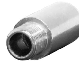
Блокиратор абонентского отвода SNR-F-lock служит для предотвращения несанкционированного доступа к абонентскому отводу делителей/ответвителей в кабельных системах распределения ТВ сигнала. Конструктивно состоит из внешнего корпуса выполненного из алюминиевого сплава и внутренней части, которая накручивается на абонентский отвод специальным ключом. Во внутреннюю часть блокиратора встроена нагрузка 75 Ом.
