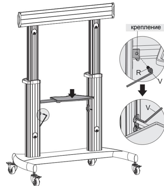
Закрепите опорную рейку с полкой в креплениях с помощью соответствующих винтов. Затяните винты шестигранным ключом.
