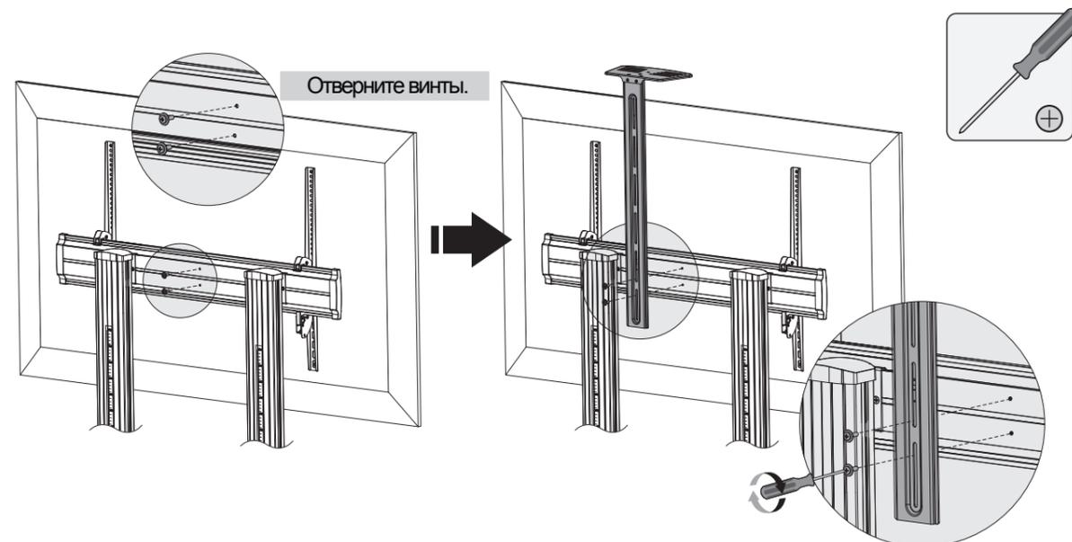
Прикрепите соединительную рейку к поперечной рейке с помощью соответствующих винтов. Затяните винты отверткой нужного типа.
