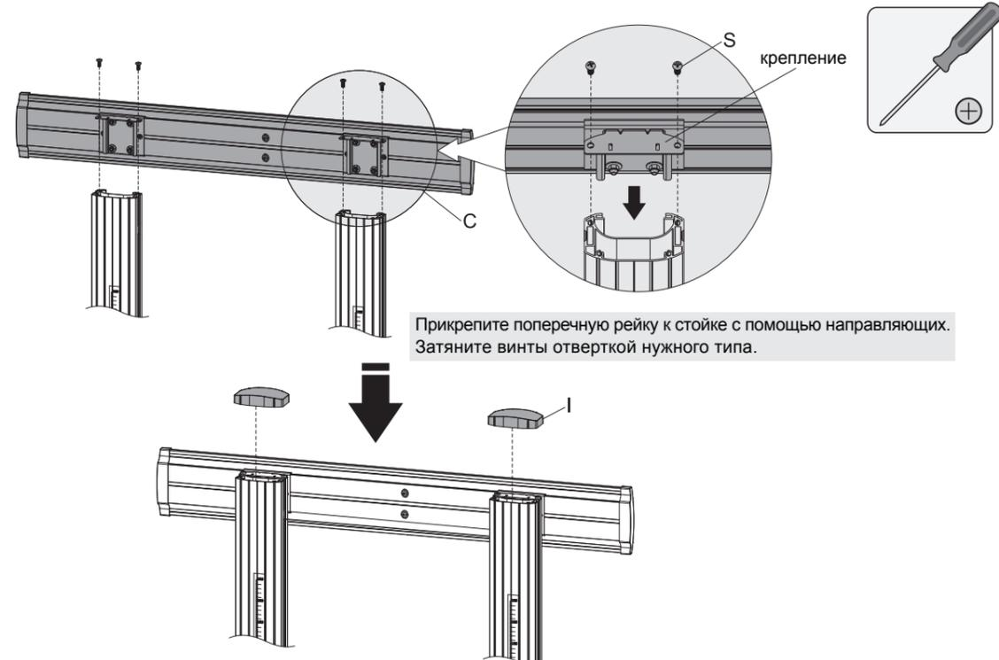
Прикрепите поперечную рейку к стойке с помощью направляющих. Затяните винты отверткой нужного типа.
