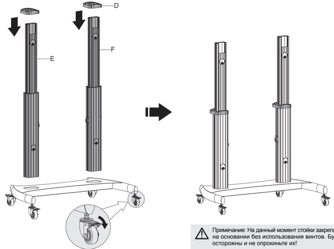
**ВНИМАНИЕ:** На данный момент стойки закреплены на основании без использования винтов. Будьте осторожны и не опрокиньте их!
