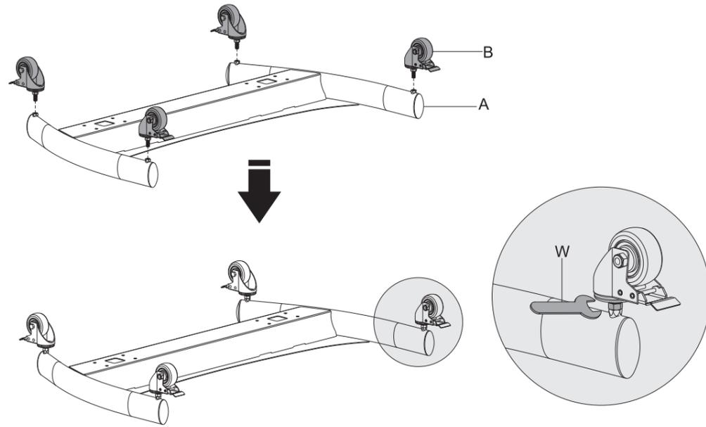
Примечание: Каждый ролик регулируется независимо для точного позиционирования стойки. Регулируйте высоту поворотом гайки.
