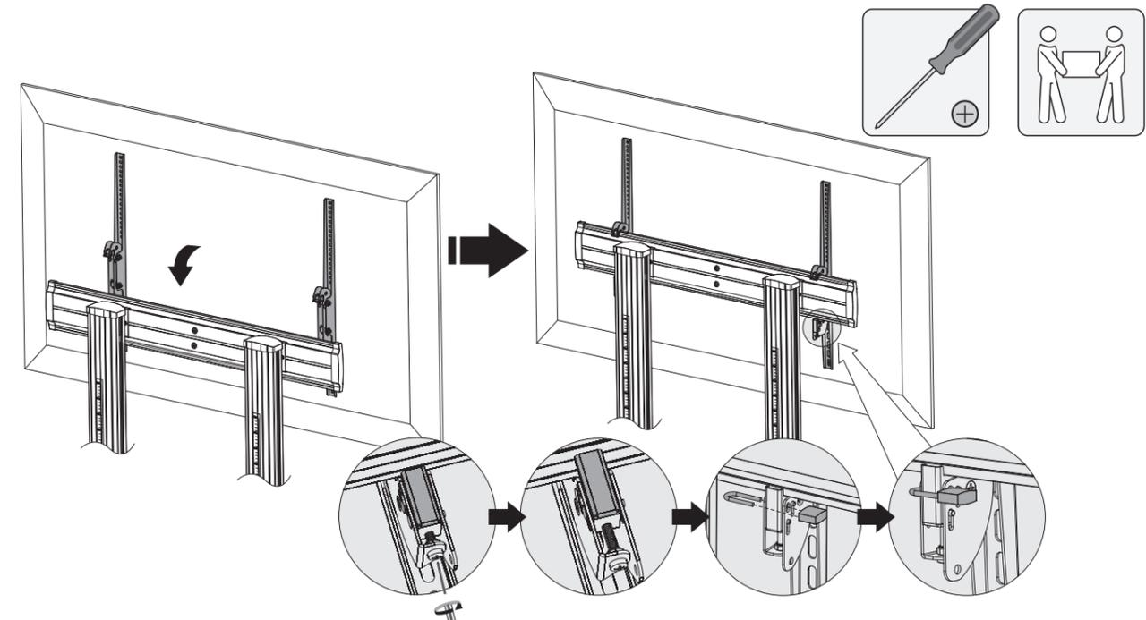
Прикрепите кронштейны с установленной ТВ-панелью к поперечной рейке. Поверните нижние винты против часовой стрелки, чтобы зафиксировать конструкцию. Поверните нижние винты по часовой стрелке, чтобы разобрать конструкцию. Используйте замок, чтобы предотвратить кражу ТВ-панели (замок в комплект не входит). **ВАЖНО:** Убедитесь в правильной установке ТВ-панели перед включением.
