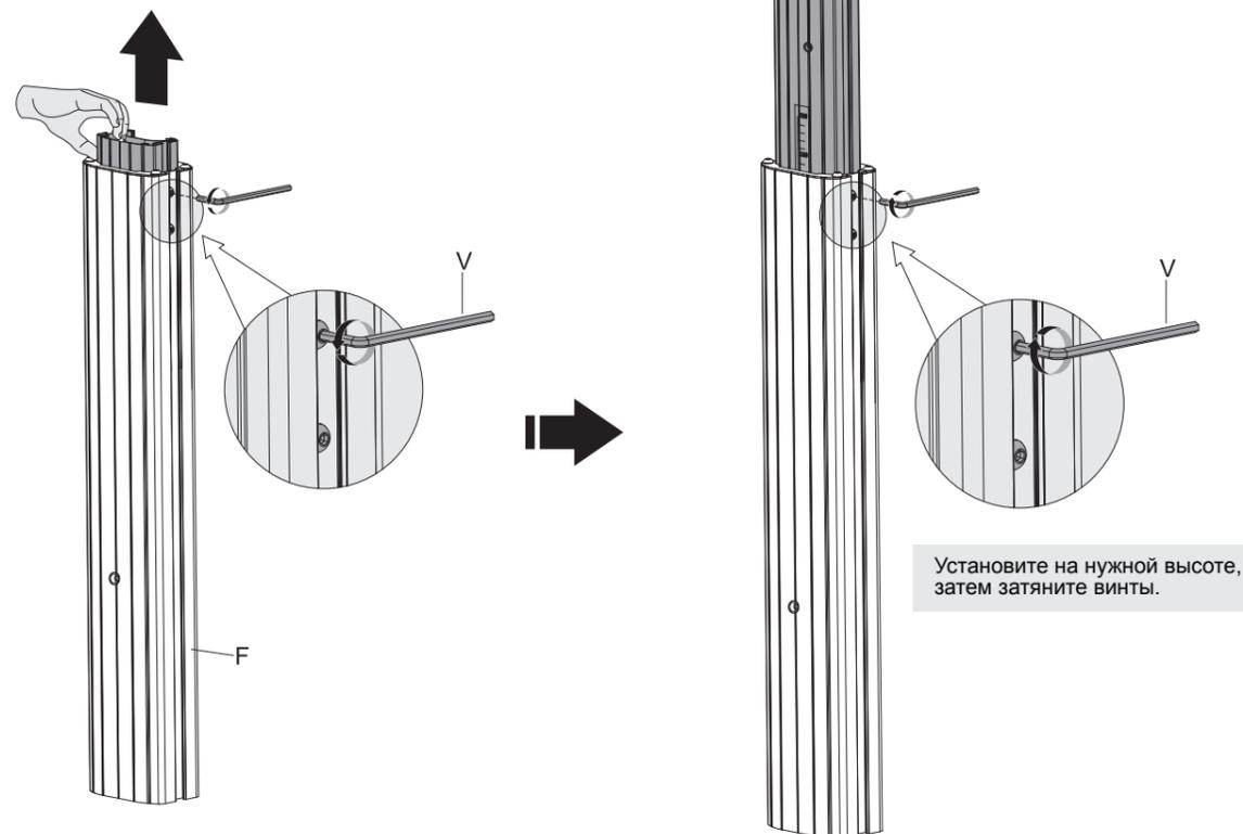
Установите на нужной высоте, затем затяните винты.
