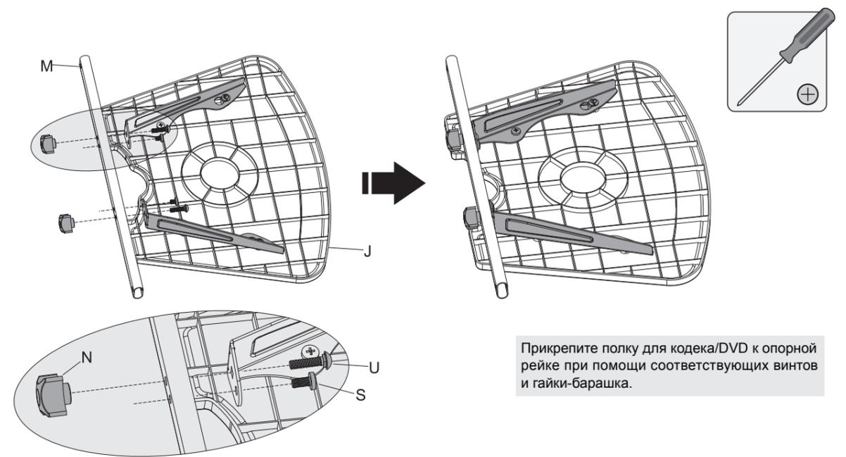
Прикрепите полку для кодека/DVD к опорной рейке при помощи соответствующих винтов и гайки-барашка.
