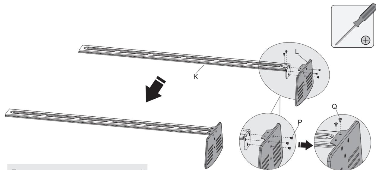
Прикрепите полку для камеры к соединительной рейке с помощью соответствующих винтов. Затяните винты отверткой нужного типа.
