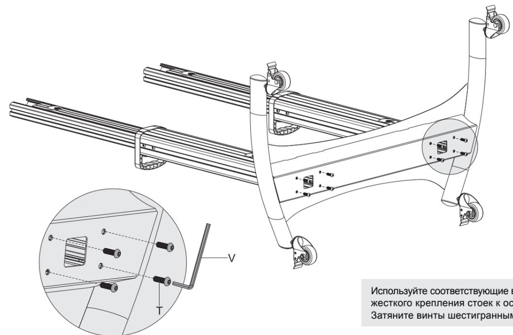
Используйте соответствующие винты для жесткого крепления стоек к основанию. Затяните винты шестигранным ключом.
