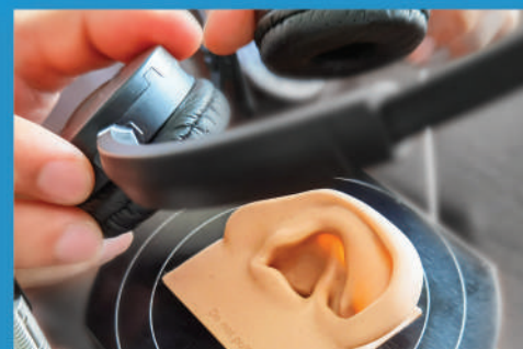
Разработка новой модели. "Искусственное ухо" – аппарат для измерения силы давления наушников на ушную раковину
