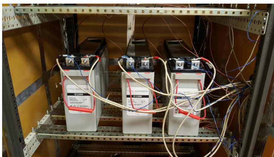
7. Вид образцов №2, №3, №4 при установке в термошкаф
