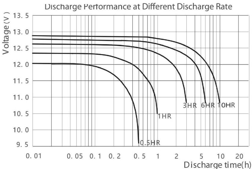
Рисунок 1 - Производительности разряда при различной скорости
