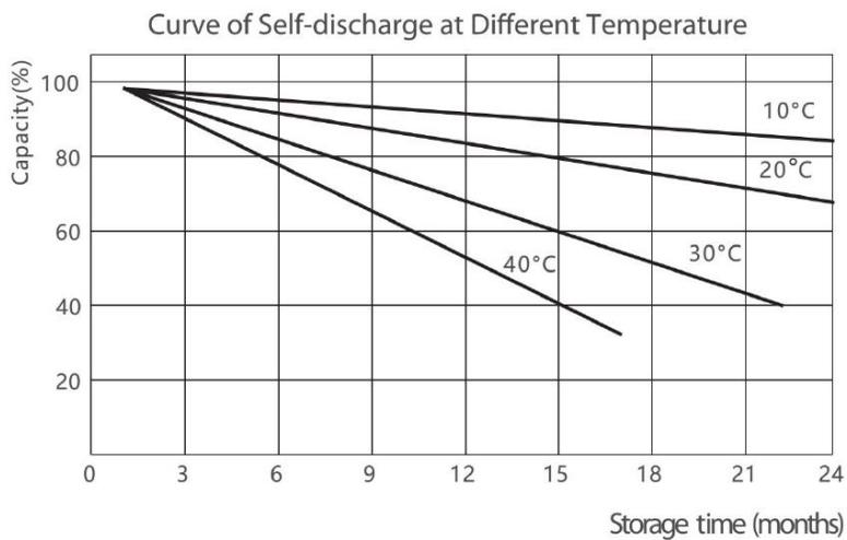
Рисунок 4 - Кривая саморазряда при разной температуре
