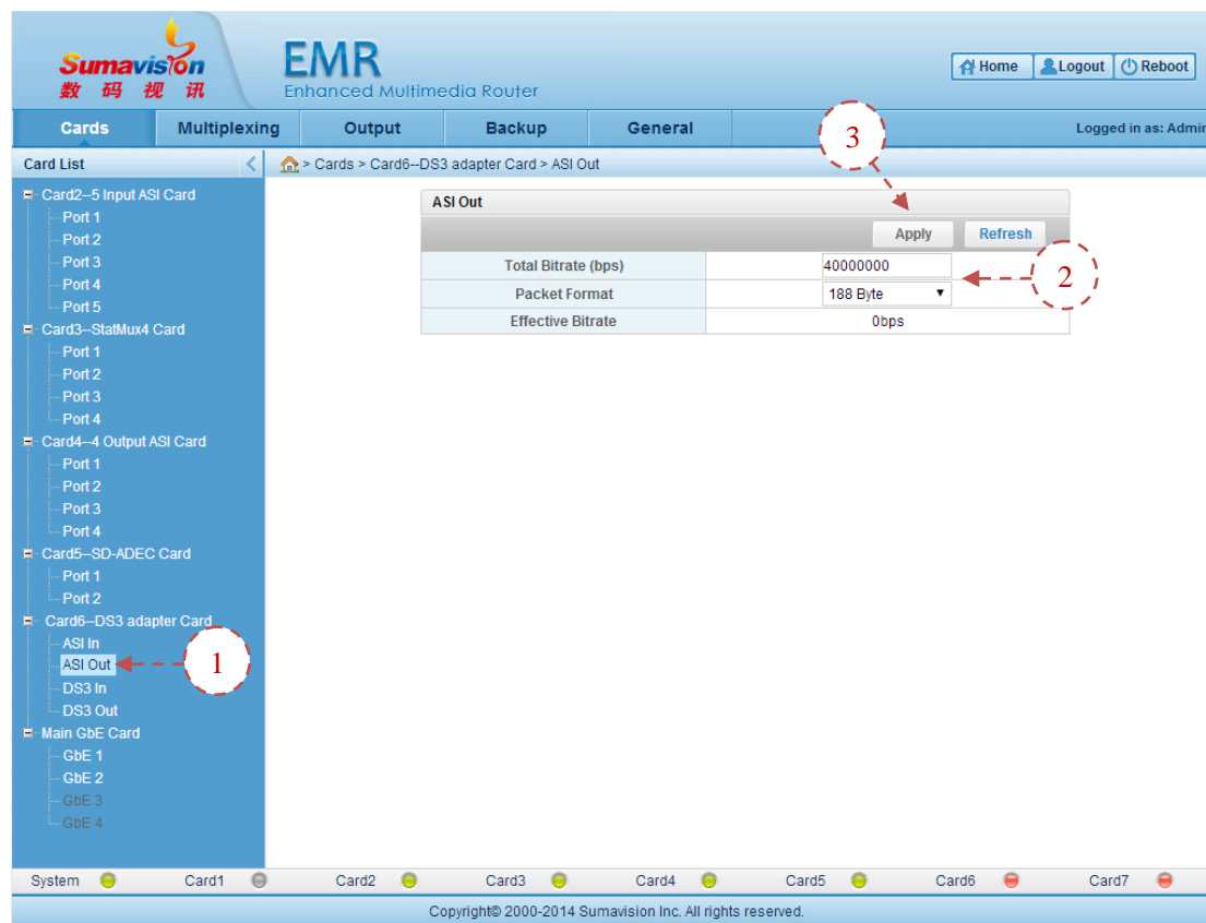
Fig. 5-50 DS3 adapter Card ASI Output Parameter Setting
