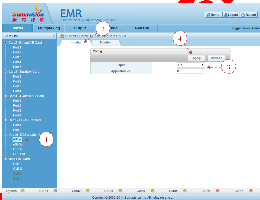
Fig. 5-46 DS3 Adapter Card ASI Input Parameter Setting
