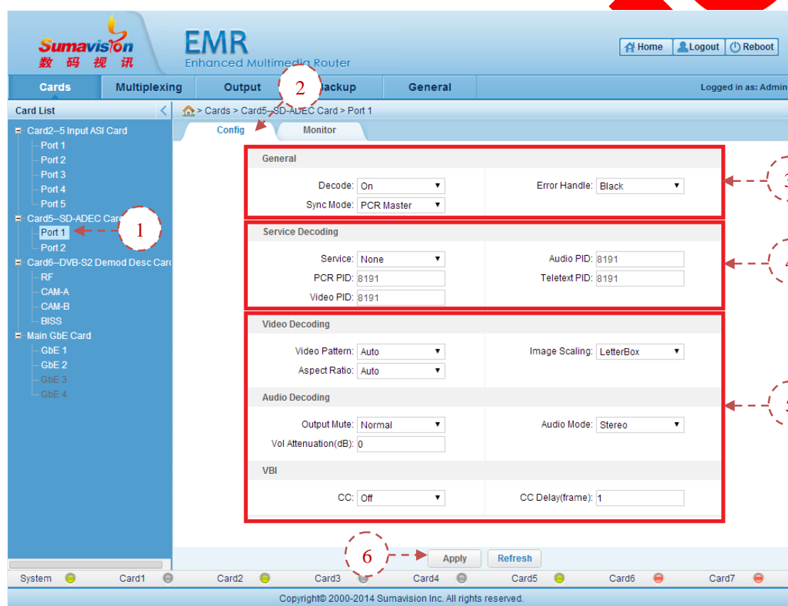
Fig. 5-75 SD-ADEC Card Port Parameter Config
