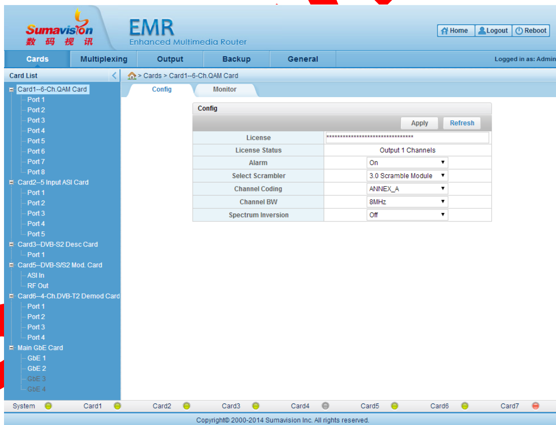
Fig. 5-55 6-Ch.QAM Card Parameter Config
