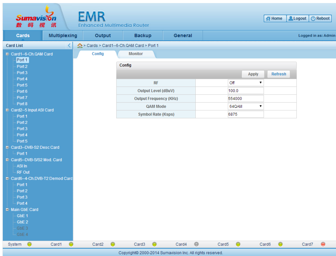
Fig. 5-56 6-Ch.QAM Card Port Parameter Config
