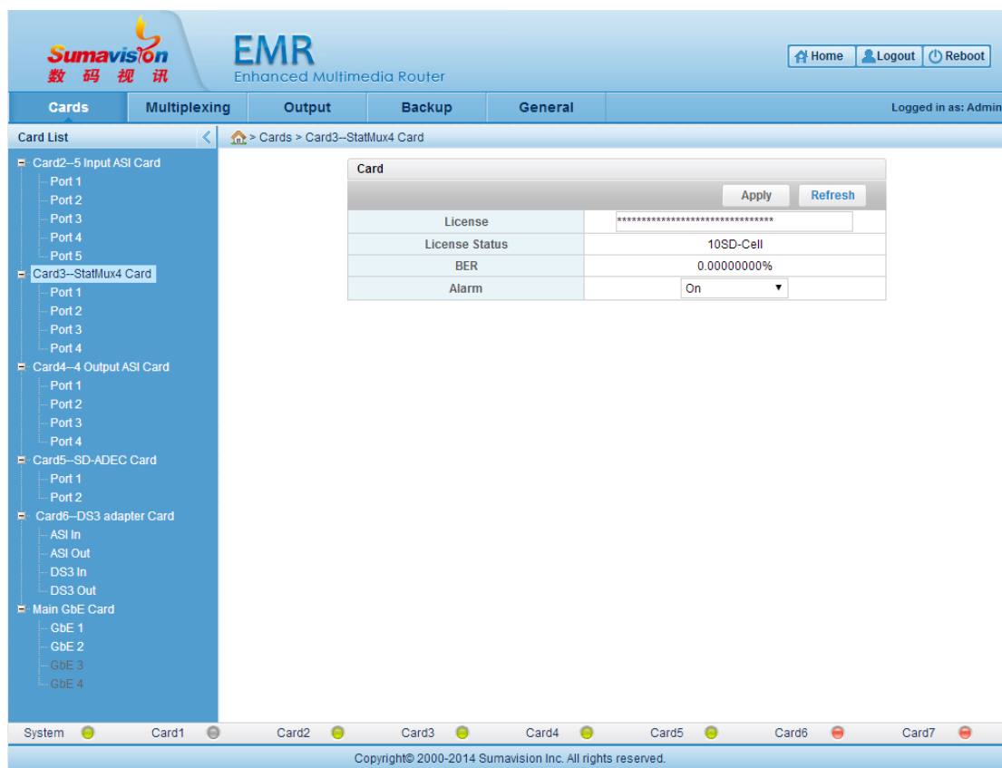
Fig. 5-117 StatMux4 Card Parameter Setting
