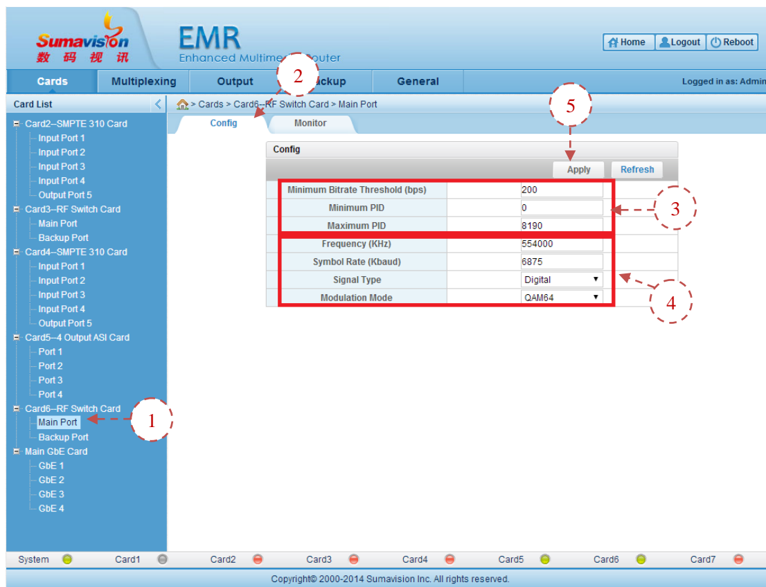
Fig. 5-137 RF Switch Card Port Parameter Setting
