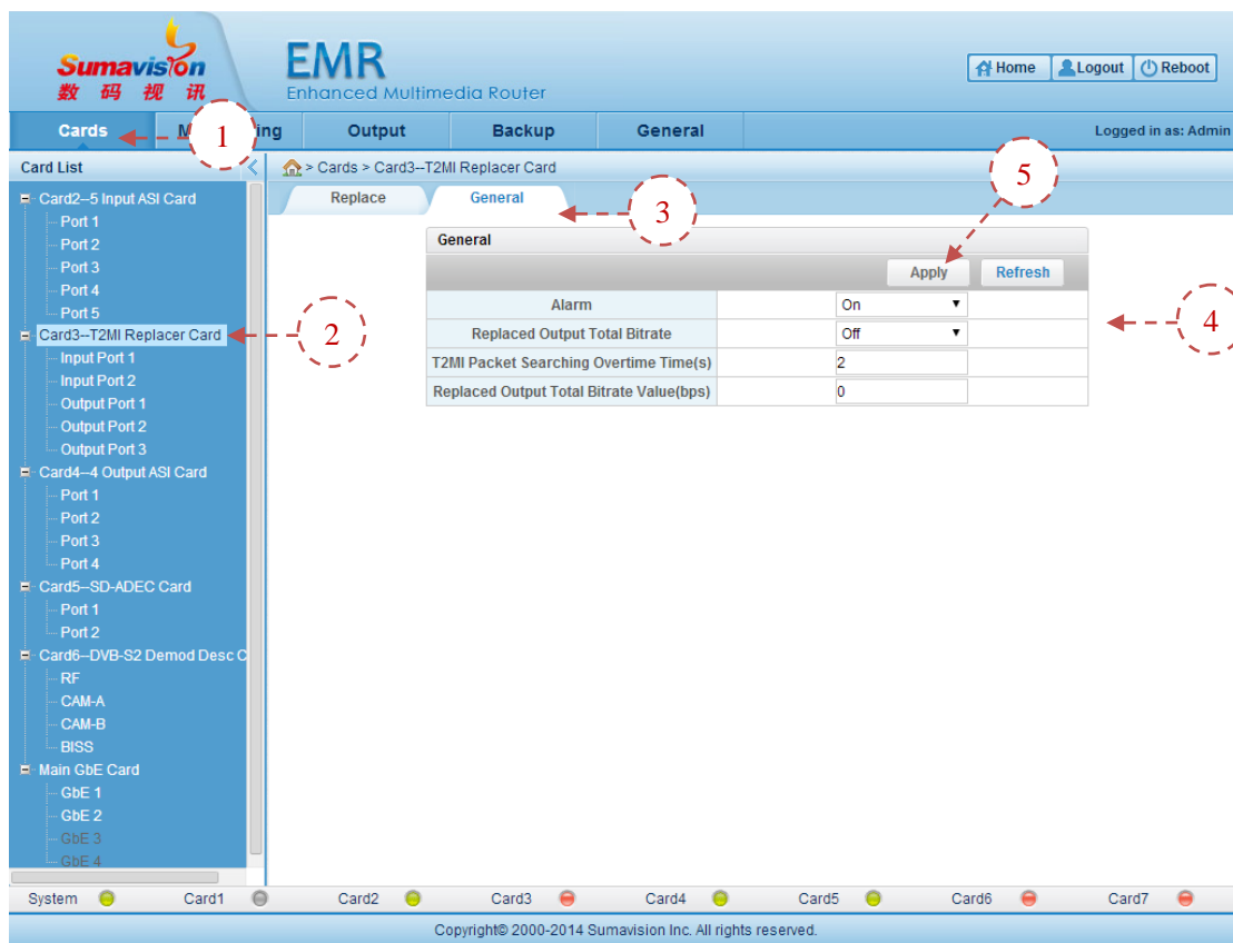
Fig. 5-140 T2MI Replacer Card General Parameter Setting
