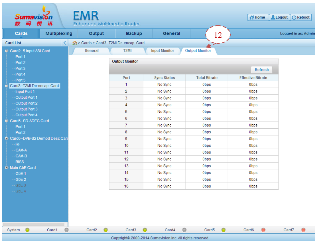
Fig. 5-157 T2MI De-encap. Card T2MI Output Monitor
