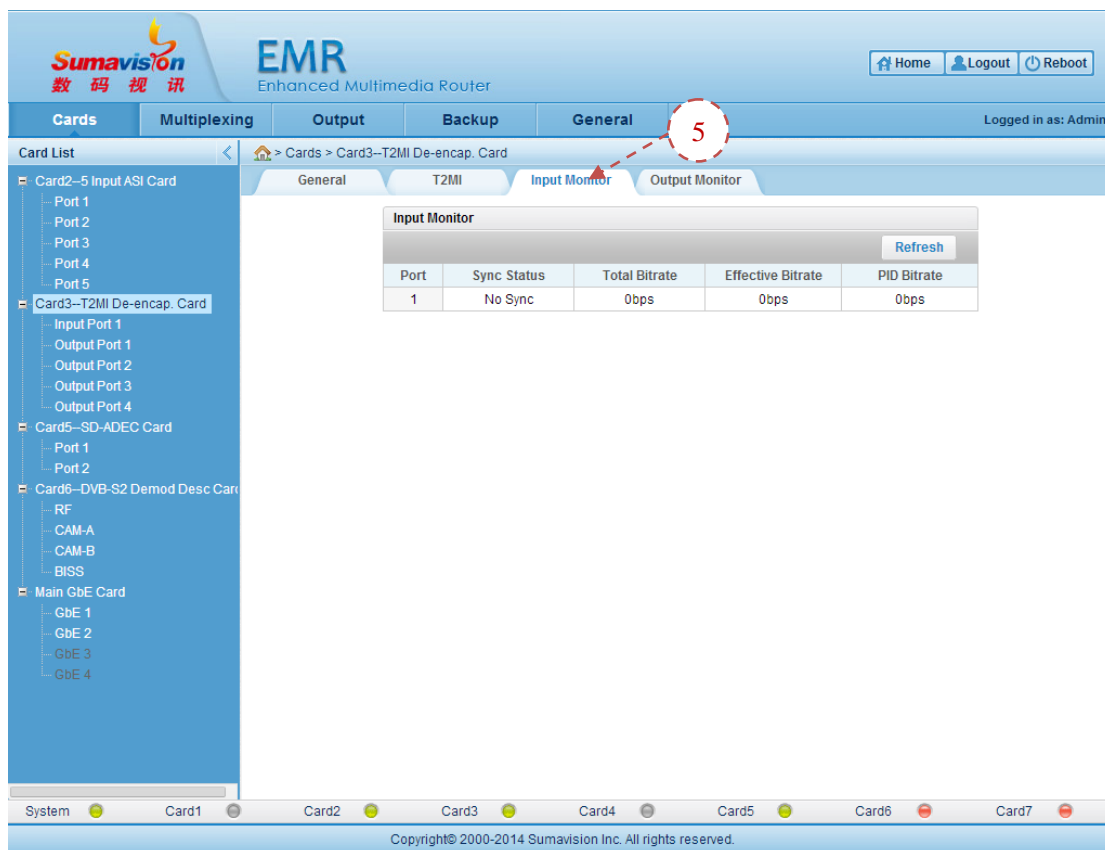
Fig. 5-150 T2MI De-encap. Card Input Monitor
