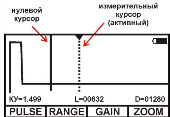
При нажатии кнопки [MODE] прибор покажет кабель полностью. Этот режим называется «КАРТА». Повторное нажатие приведет к восстановлению установленной растяжки вокруг активного курсора. Вы можете то просмотреть кабель целиком, то только область растяжки. В режиме «КАРТА» прибор выводит карту кабеля, и экран принимает вид, показанный на рисунке.
