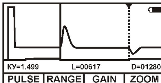
Установив курсоры, вернитесь в «карман» для кабеля. Сбросьте пункт <Измер.Укорочения> в состояние <НЕТ> кнопкой [OK]. Измеренный коэффициент укорочения будет записан в параметры кабеля.
