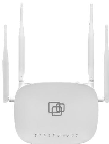
SNR-CPE это высокопроизводительные маршрутизаторы разработанные компанией ООО «НАГ», и предназначенные для организации проводной и беспроводной связи. Подходят для использования в сетях оператора и корпоративных сетях.
