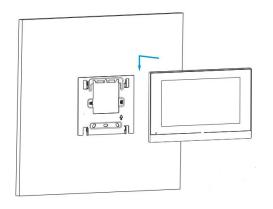
Приложите панель на кронштейн таким образом, чтобы 4 фиксирующих лапки кронштейна зашли в пазы панели.
