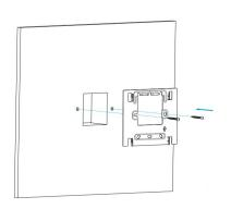
Приложите кронштейн к стене и зафиксируйте его с помощью шурупов из комплекта поставки, вкрутив их в ранее установленные дюбели.
