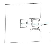
Установите кронштейн панели на монтажную коробку с помощью винтов М4х30 из комплекта поставки в специальные отверстия (расстояние между отверстиями должно быть 60мм).
