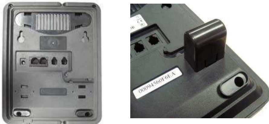
Рис. 3 Вид снизу и установка пластиковых ножек
