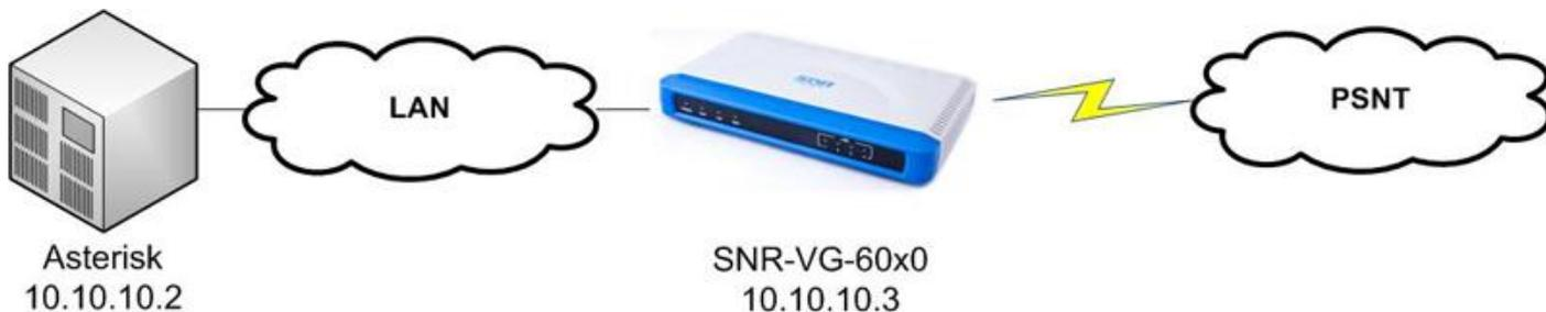
Ниже рассматривается схема, позволяющая Вашей IP-PBX принимать вызовы, совершенные на номера ТФОП, а также совершать исходящие звонки посредством использования старых аналоговых линий (на примере Asterisk (Elastix) и шлюза SNR-VG-6040)
