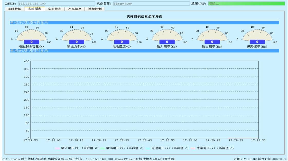
三相界面显示包括电池电压、电池电流、电池温度、电池容量、输出负载的图表信息，输入电压频率、输出电压频率、旁路电压频率的动态曲线图表。
