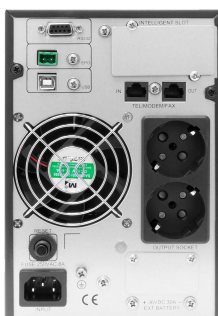
Рисунок 2 - Общий вид задней панели ИБП
