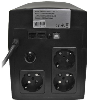
Рисунок 2 - Общий вид задней панели ИБП
