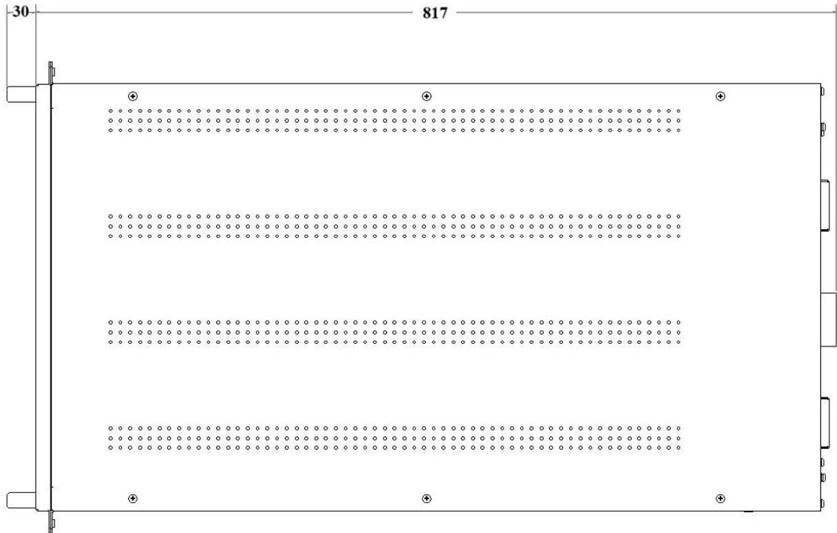
РИСУНОК 7 – ГАБАРИТНЫЕ РАЗМЕРЫ. ВИД СВЕРХУ
