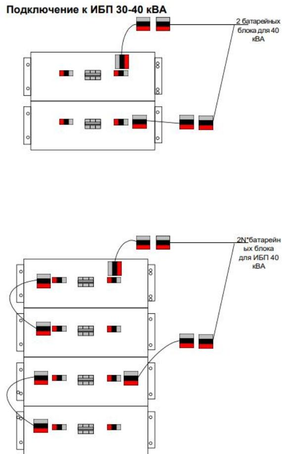
РИСУНОК 10 - ПОДКЛЮЧЕНИЕ К ИБП 30-40 КВА
