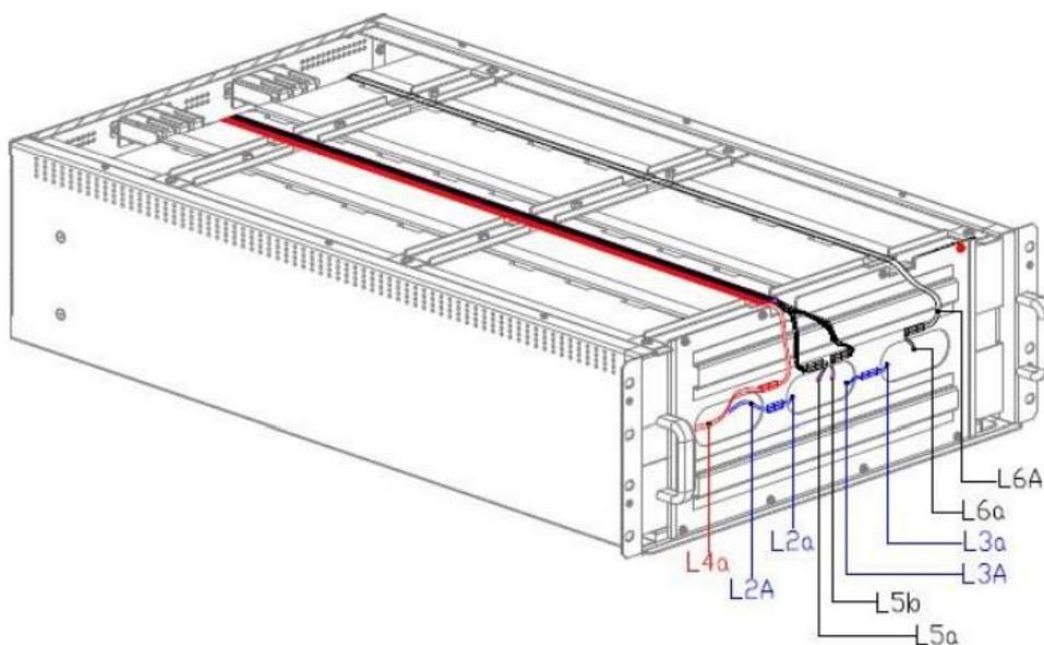
РИСУНОК 13 - ПОДКЛЮЧЕНИЕ КАБЕЛЕЙ
